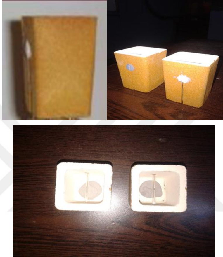
Şekil 5.21. Tellür içeren quickcab
