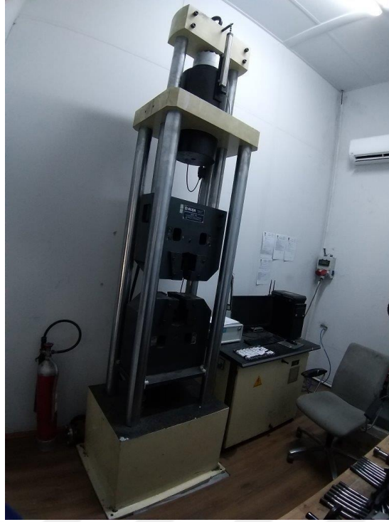
Şekil 5.22. Alşa marka 30 ton'luk PLC-Hidrolik kontrollü çekme cihazı
