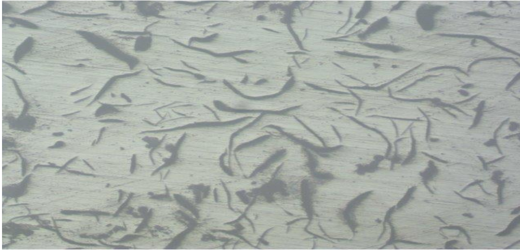
Şekil 5.19. ZM6 %0.30 aşılı mikroyapı görüntüsü
