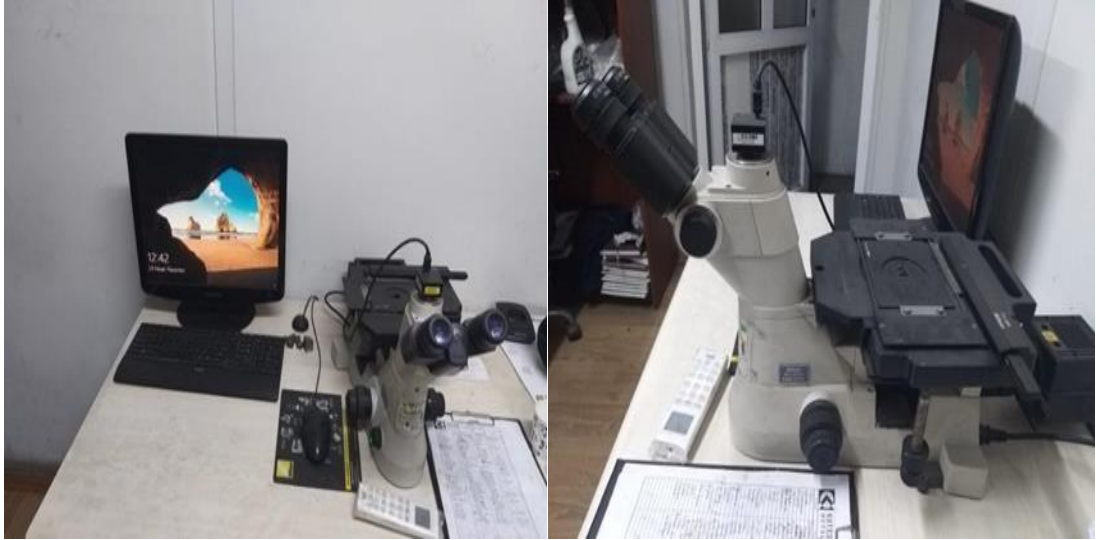
Şekil 5.3. Nikon marka MA100 model optik metal mikroskobu
