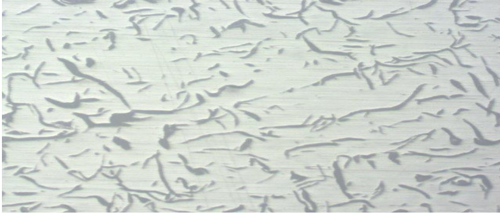
Şekil 5.8. VP316 %0.25 aşılı mikroyapı görüntüsü
