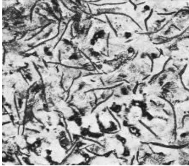
Şekil 5.1. A- tipi grafit ve gri katlaşmış lamel grafitli dökme demirin mikroyapısı (Inoculation cast iron)
