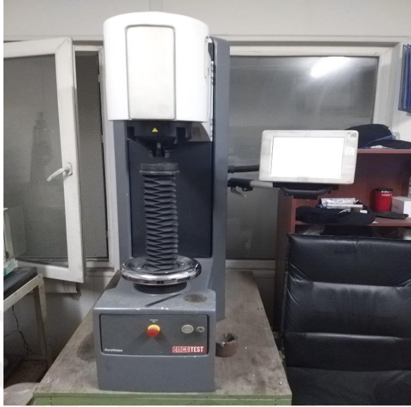
Şekil 5.26. Emcotest Duravision marka sertlik ölçme cihazı
