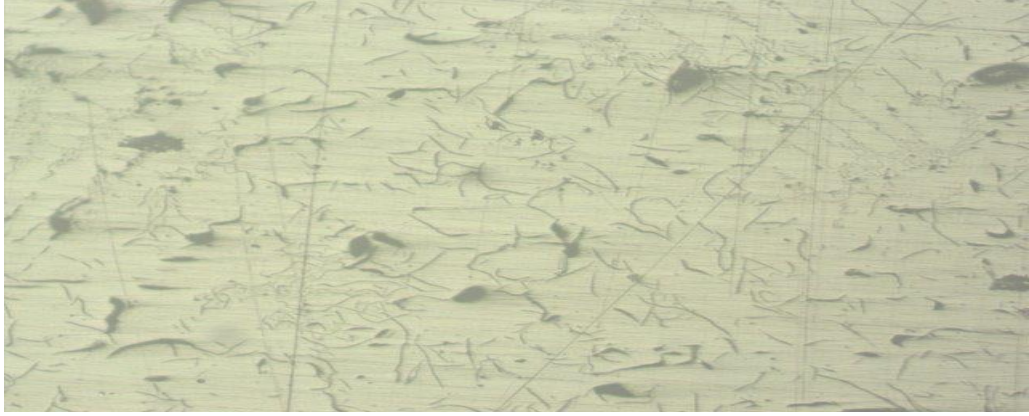
Şekil 5.10. SB5 %0.12 aşılı mikroyapı görüntüsü
