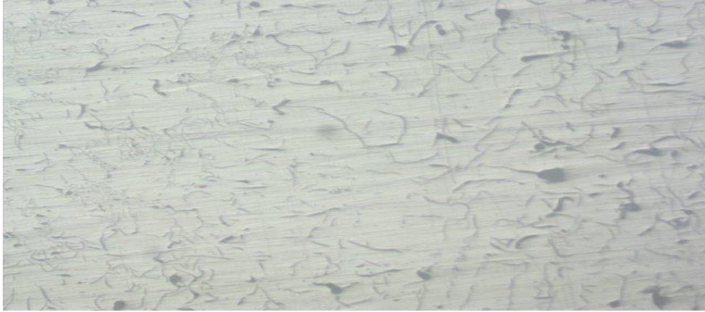
Şekil 5.16. ZM6 %0.15 aşılı mikroyapı görüntüsü
