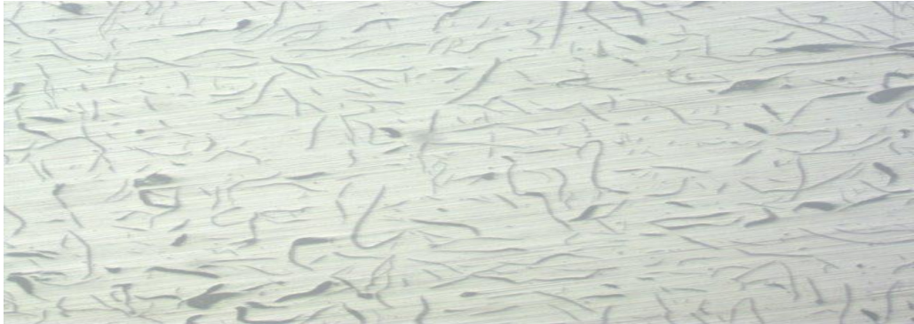
Şekil 5.11. SB5 %0.15 aşılı mikroyapı görüntüsü
