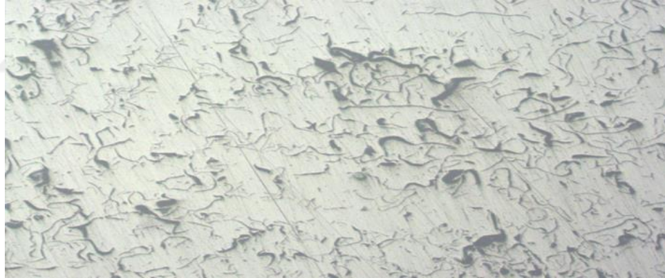
Şekil 5.5. VP316 %0.12 aşılı mikroyapı görüntüsü
