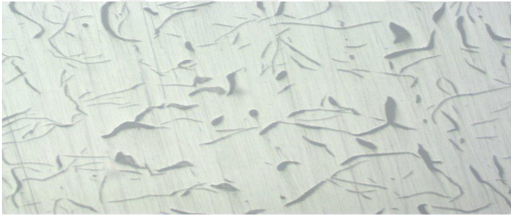
Şekil 5.17. ZM6 %0.20 aşılı mikroyapı görüntüsü
