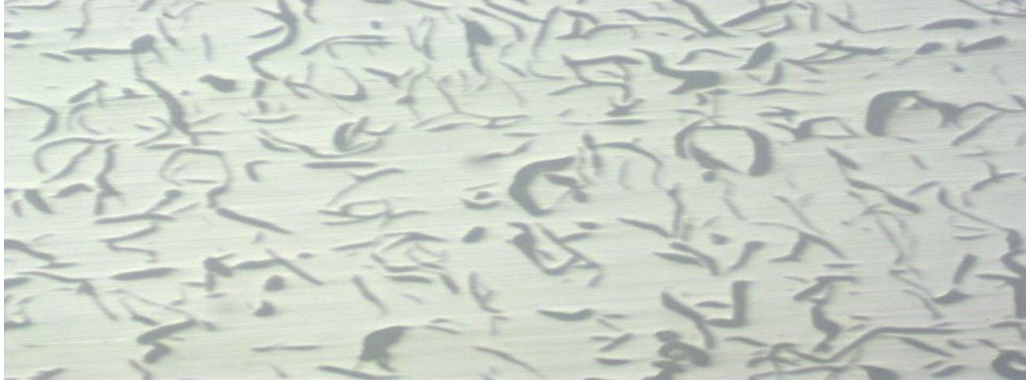
Şekil 5.18. ZM6 %0.25 aşılı mikroyapı görüntüsü
