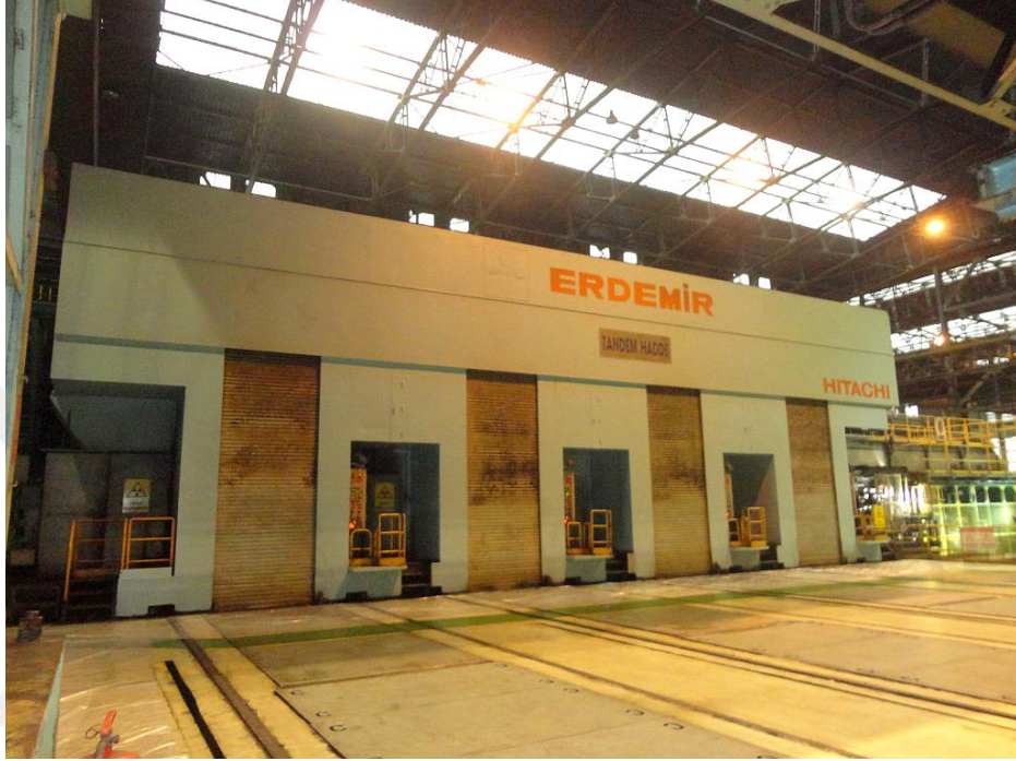
Şekil 4.3. Deneysel Çalışmanın yapıldığı Sürekli Tandem Hadde
