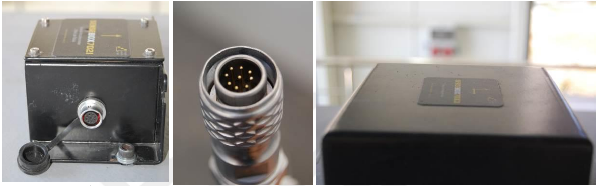
Şekil 9.5. İvmeölçerler, tek eksenli ivmeölçer (solda), Veri bağlantısı (ortada), üç eksenli ivmeölçer (sağda)
