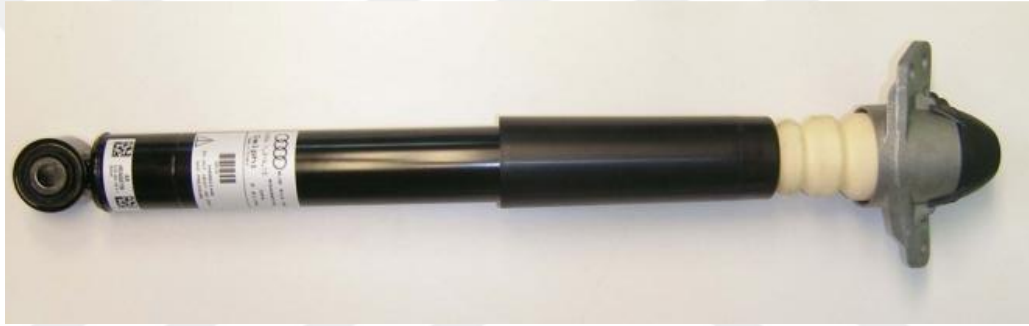
Şekil 2.7. Audi tarafından 2006 yılında TT ve R8 modellerinin süspansiyonu için üretilen MR damper[24]
