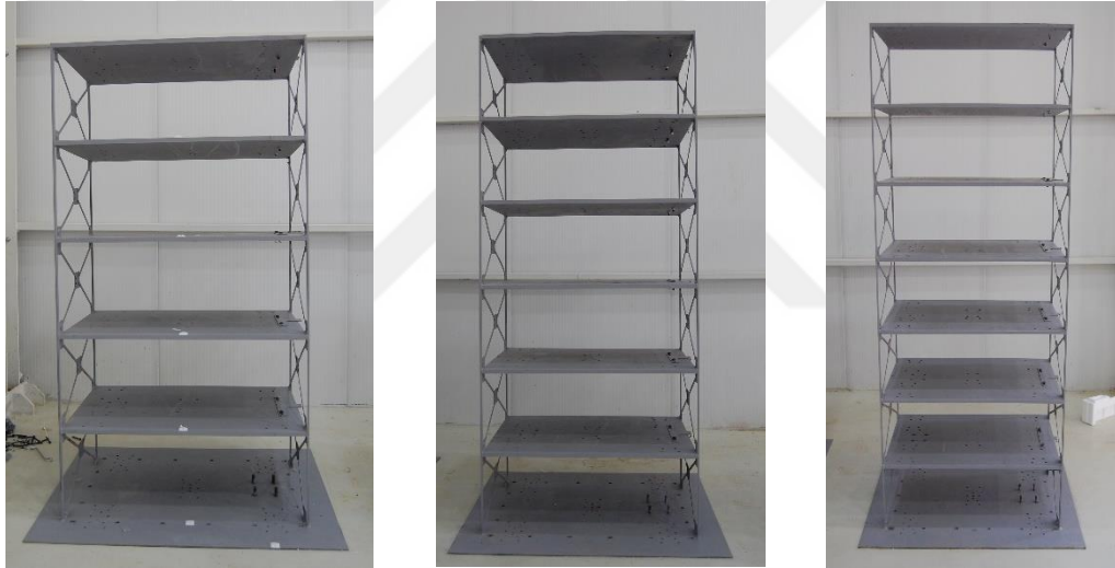
Şekil 9.3. Ölçeklendirilmiş çelik yapı modelleri, 5 katlı (solda), 6 katlı (ortada), 7 katlı (sağda)
