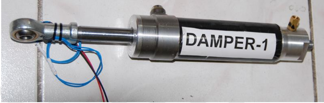
Şekil 6.3. Üretilen MR damper
