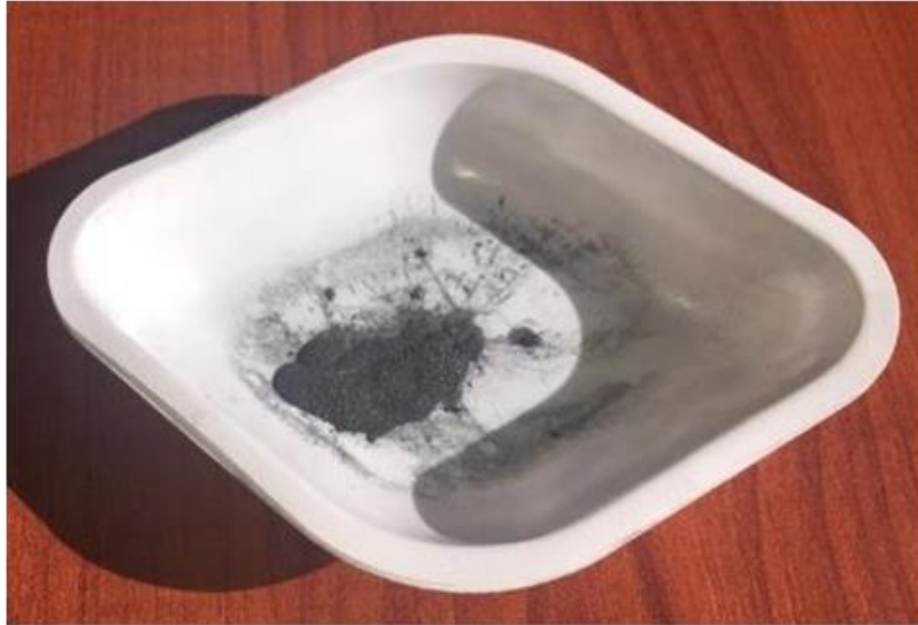
Şekil 5.5. Çekirdekleştirici olarak kullanılan B 4 C tozu.
