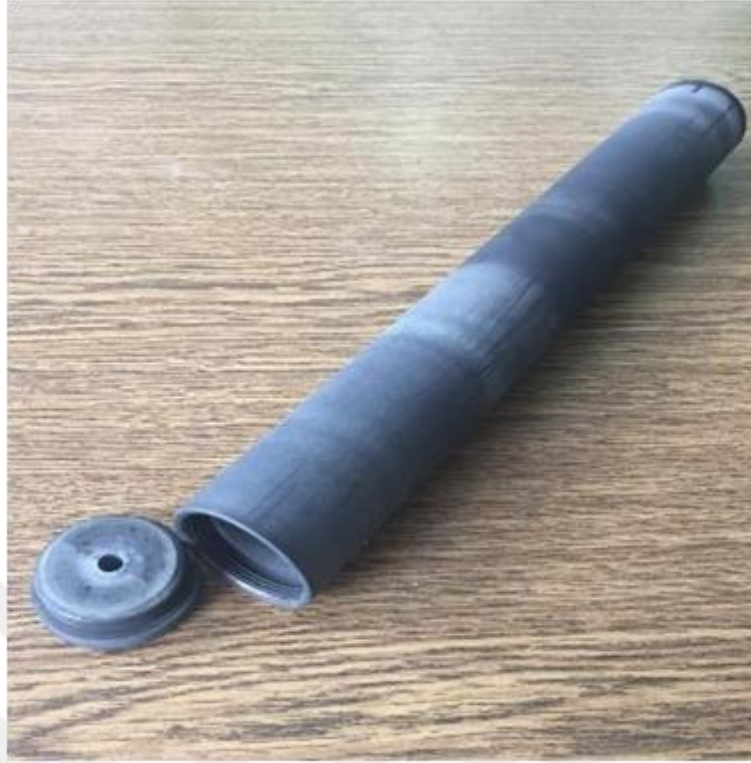
Şekil 5.7. Kullanılan refakter esaslı (grafit) reaktör
