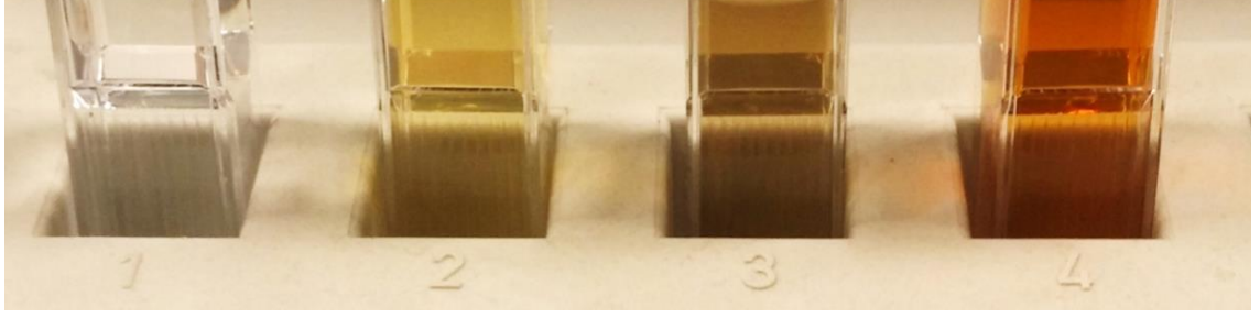
Şekil 4.2 Gümüş nanopartiküllerin oluşumu ve yüzey plazmon rezonansı
