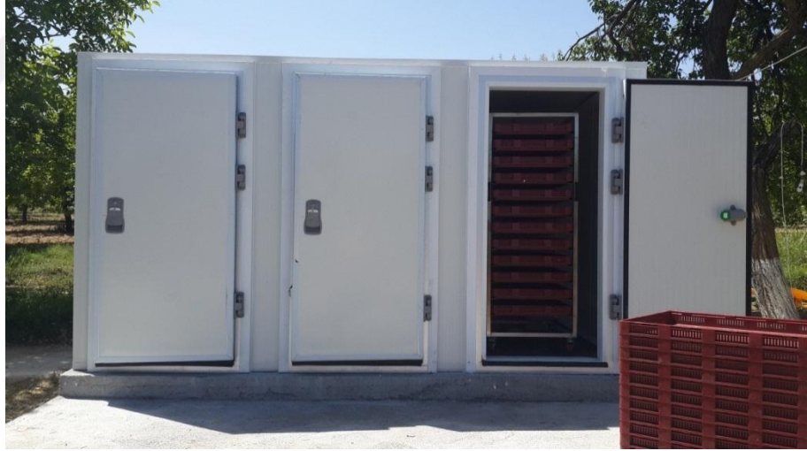
Şekil 3.2 Kerevetlerin vagon halinde islim odasına yerleştirilmesi
