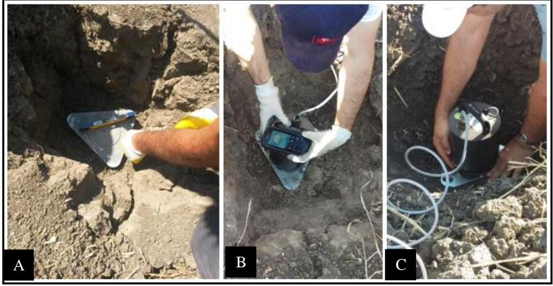
Şekil 5.4.A. Ölçüm çukuruna metal tablanın yerleştirilmesi, B. sismometrenin metal tabla üzerine konularak coğrafik kuzeye yönlendirilmesi, C. Son olarak sismometrenin yatay düzlemde denge konumuna getirilmesi
