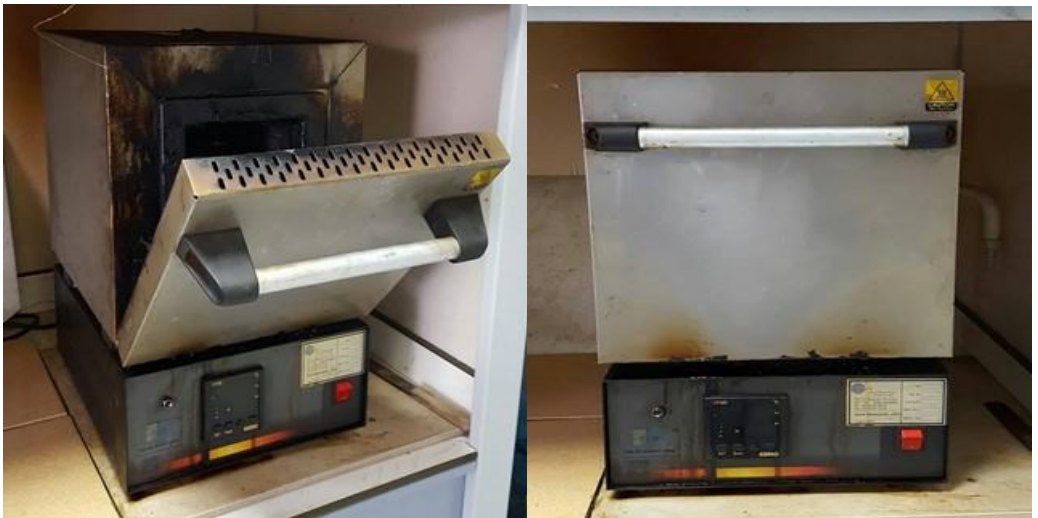
Şekil 3.1 Biyokömürün elde edildiği yakma fırını (Foto: A. Ouedraogo)
