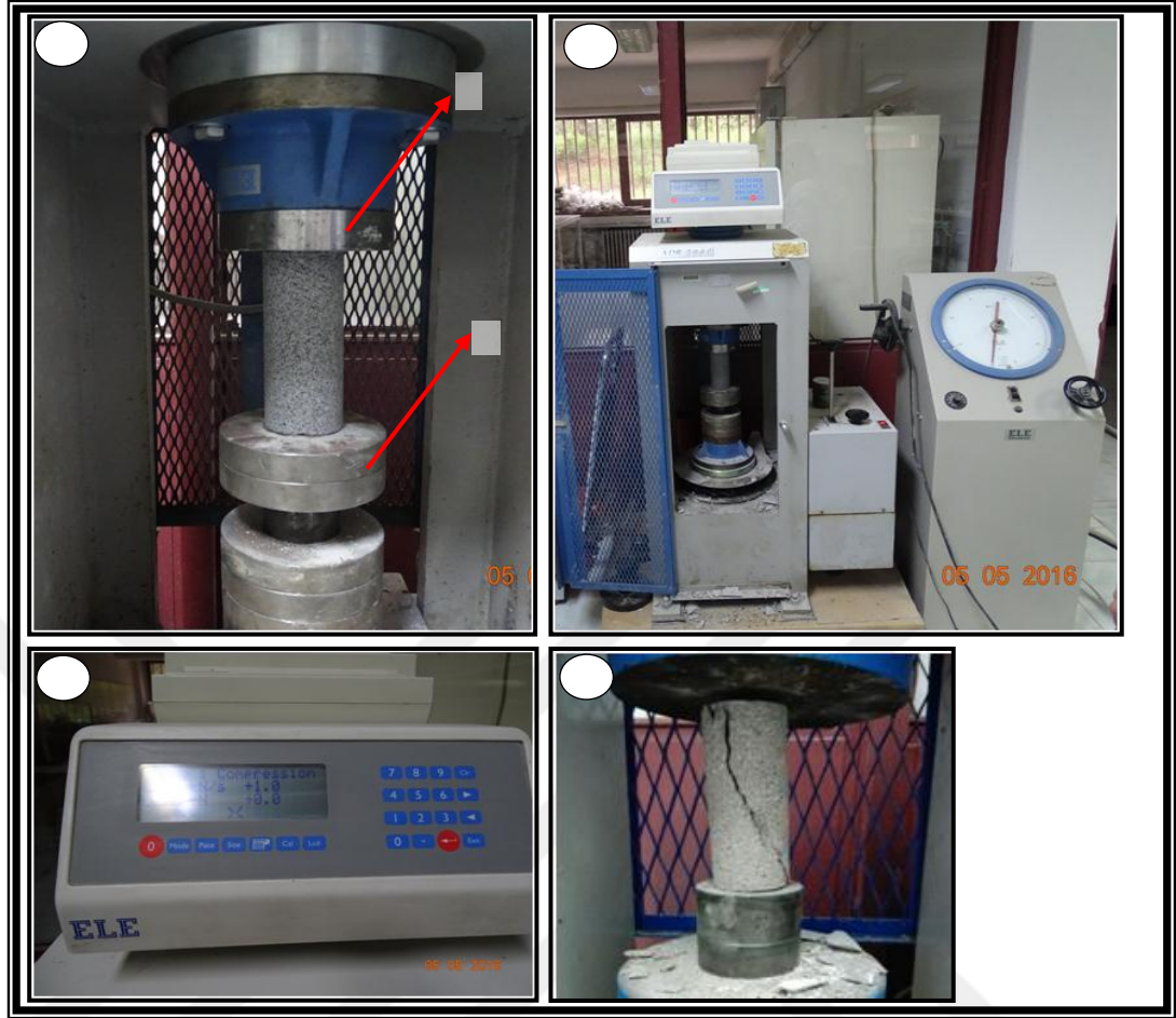
Şekil 2.4.a. Hidrolik pres ve yükleme başlıkları (1: küresel başlık, 2: sabit alt plaka), b. yükleme hızının ayarlanabildiği ve okumaların yapıldığı kontrol paneli, c. tek eksenli sıkışma dayanım deneyinin yapılışı, d. deney sonrası örneklerde oluşan yenilme yüzeyinin görünümü
