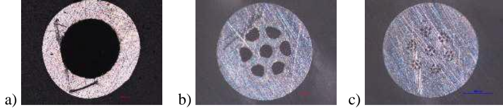
Şekil 3.7.a. 1 damarlı, b. 7 damarlı, c. 49 damarlı M serisine numunelerin optik mikroskobu ile alınan görüntüleri
