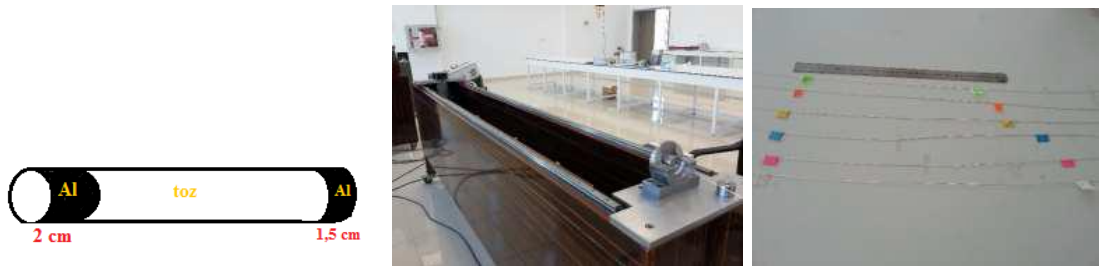
Şekil 3.3 Doldurulan tüplerin şematik gösterimi, tel çekme cihazı ve çekilmiş telin başlangıç ve son hali
