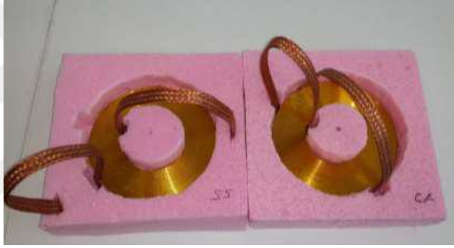
Şekil 3.12 Satın alınan şeritten bobin sarımı esnasında çekilen fotoğraflar
