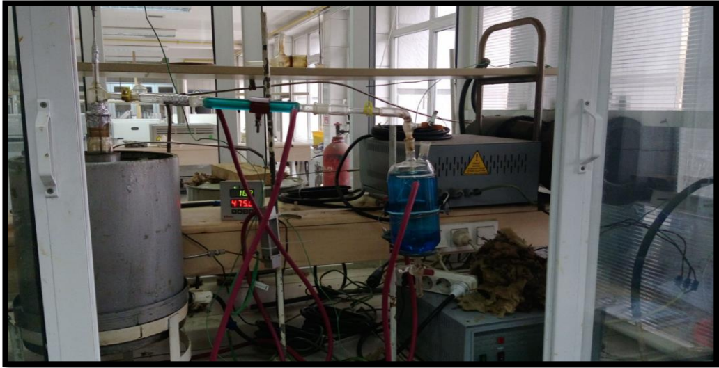
Şekil 3.11 Isıl/katalitik deneylerin yapıldığı piroliz deney sisteminin fotoğrafı
