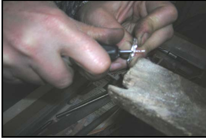
Fotoğraf No:206.Kolye ucunun freze ile delinmesi işlemi.
