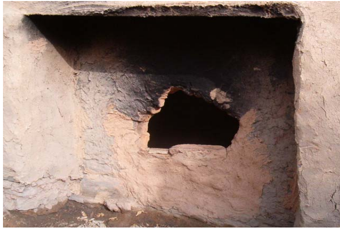
Fotoğraf No:186. Konya'da Yaşar Bulut seramik atölyesinde bulunan odunlu fırının birinci katı.
