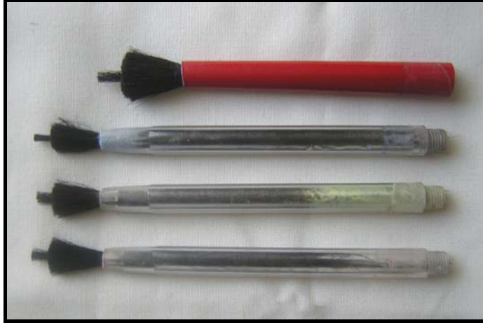
Fotoğraf No:151.Seramik takımın dekorlanmasında kullanılan eşek yelesinden yapılan boyama fırçası.
