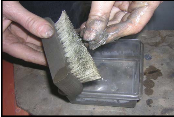
Fotoğraf No:214.Gümüş kolye ucunun sabunlu suda kıl fırça ile fırçalanması işlemi.
