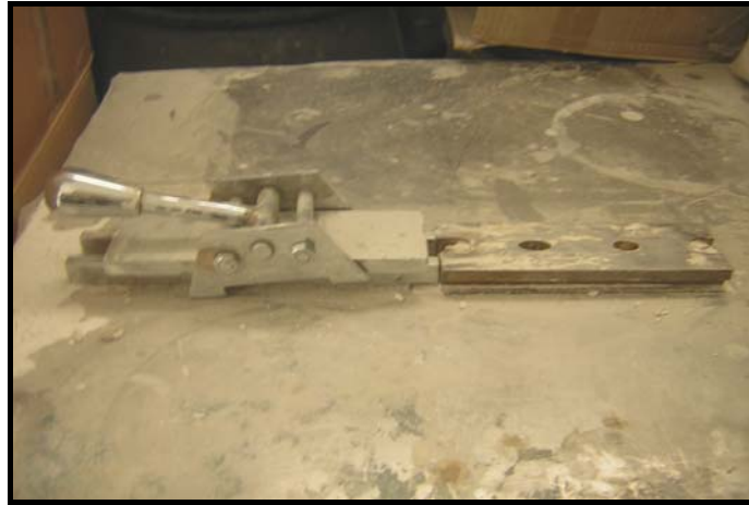
Fotoğraf No:173.Seramik takı altyapılarının şekillendirildiği pres aleti.
