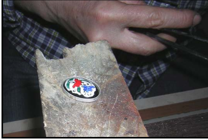
Fotoğraf No:196.Gümüş şeridin bisküviye yerleştirilerek kontrol edilme işlemi.
