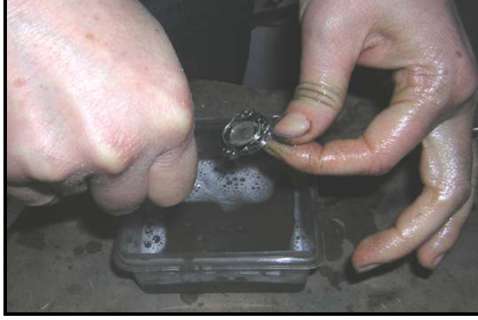
Fotoğraf No:215.Gümüş kolye ucunun su ile durulanması işlemi.
