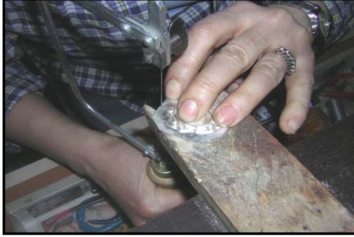
Fotoğraf No:204.Gümüş helezonların dış çevresinden kıl testere ile kesme işlemi.
