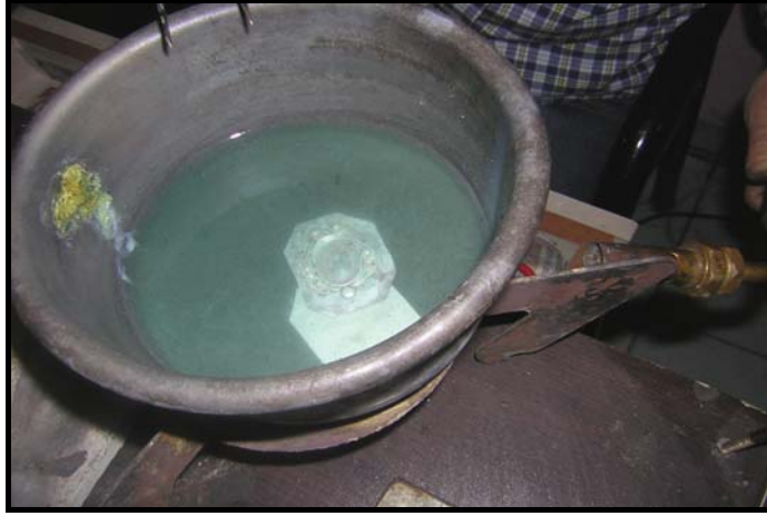
Fotoğraf No:202. Gümüş levhanın jalom ile asitte kaynatılma işlemi.
