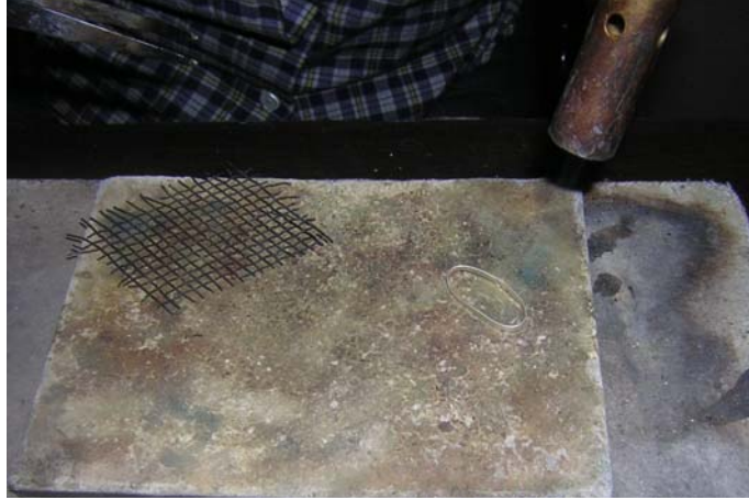
Fotoğraf No:194.Gümüş şeridin uçlarının kaynak ile birleştirilmesi işlemi.
