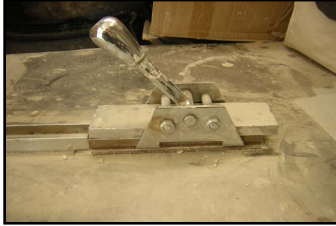
Fotoğraf No:174.Seramik takı altyapılarının şekillendirmesinde pres kolunun çekilmesi işlemi.
