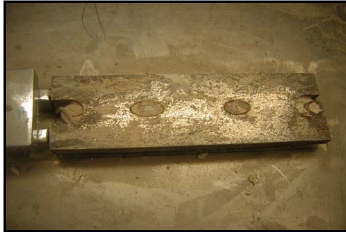
Fotoğraf No:175. Pres aletinin yüzeyindeki yuvalara yerleştirilen seramik çamurunun yuvadan çıkartılması işlemi.
