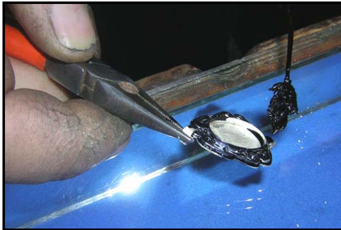
Fotoğraf No:212. Gümüş kolye ucunun ince fırça ile karartılması işlemi.
