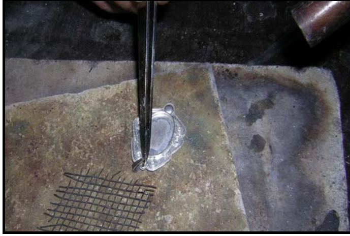
Fotoğraf No:209.Gümüş kelebeğin kaynak yapılması işlemi.
