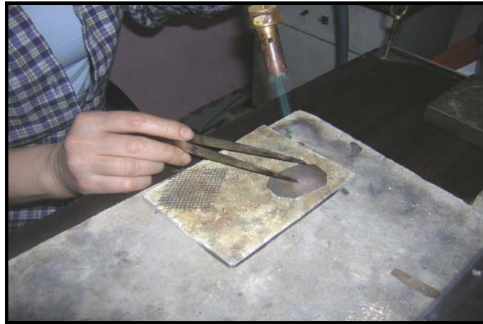
Fotoğraf No:191.Jalom ile ısıtılarak gümüş levhanın pürüzsüzleştirilmesi işlemi.
