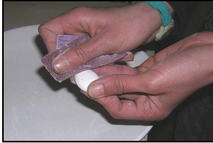
Fotoğraf No:176.Seramik takı altyapısının zımparalanma işlemi.
