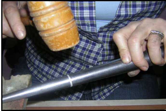
Fotoğraf No:195. Gümüş şeridin malapaya takılarak düzleştirilmesi işlemi.
