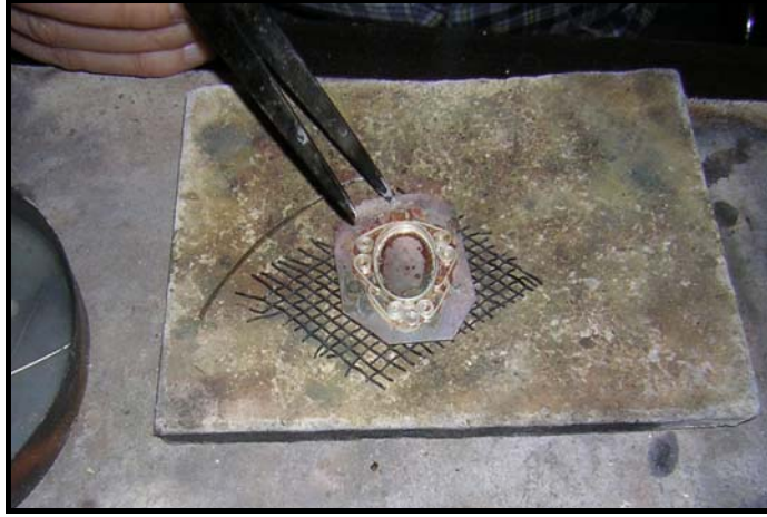
Fotoğraf No:200. Gümüş şerit helezonların kaynak yapılma işlemi.
