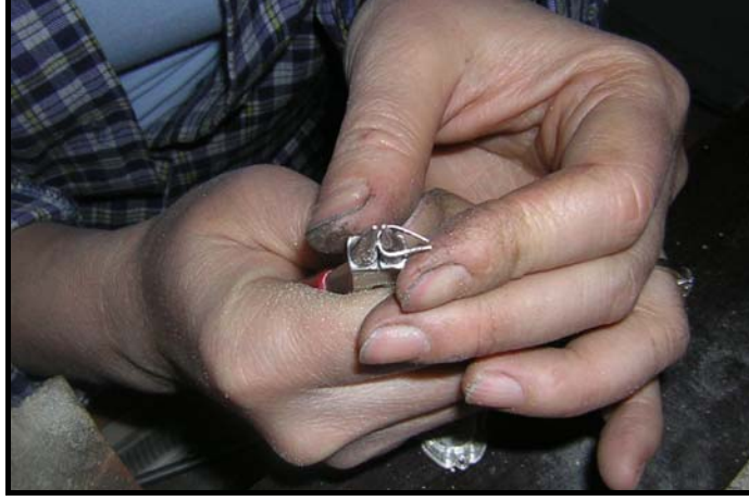
Fotoğraf No:208.Gümüş levhadan kesilen kelebeğin yuvarlak burunlu pense ile netleştirmesi işlemi.
