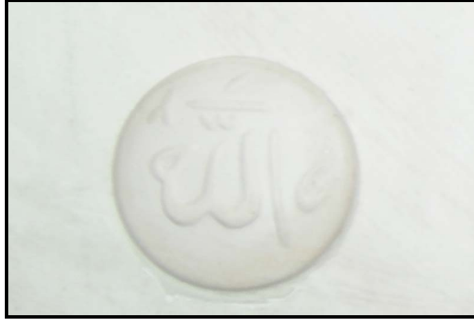
Fotoğraf No:172. Alçı kalıp ile şekillendirilen rölyefli seramik takı.
