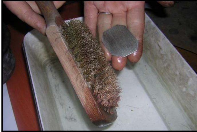
Fotoğraf No:197.Sabunlu su ile gümüş levhanın yağının alınması işlemi.
