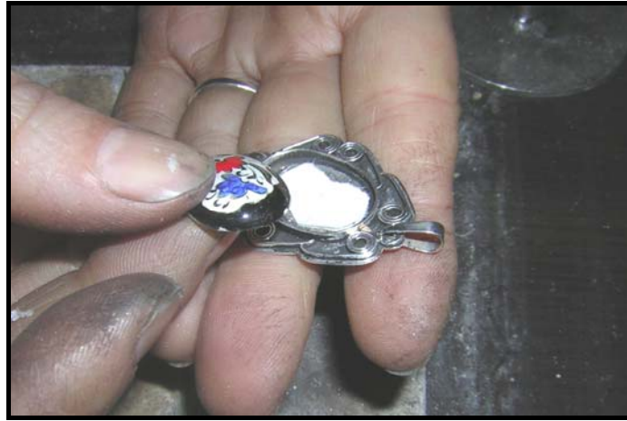
Fotoğraf No:218.Seramik altyapının yerleştirileceği yuvaya kâğıt parçasının yerleştirilmesi işlemi.
