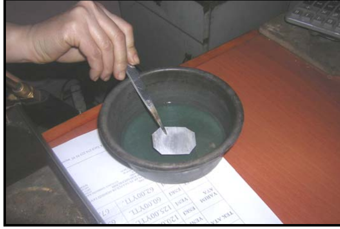
Fotoğraf No:192.Gümüş levhanın aside batırılması işlemi.
