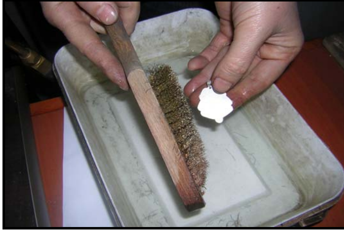
Fotoğraf No:210. Gümüş kolye ucunun sabunlu suda tel fırça temizlenmesi işlemi.
