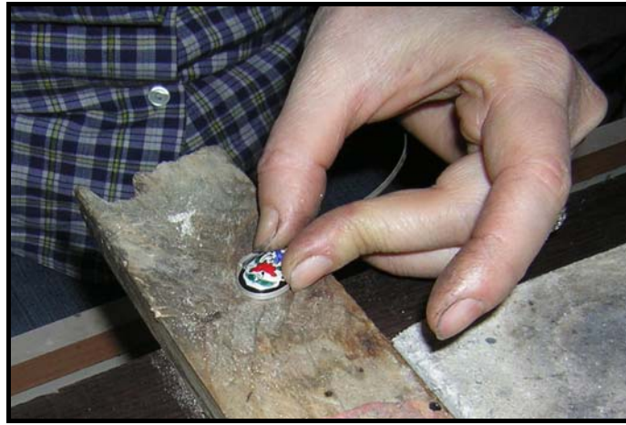
Fotoğraf No:193. Gümüş şerit ile çini bisküvisinin ölçüsünün alınması işlemi.
