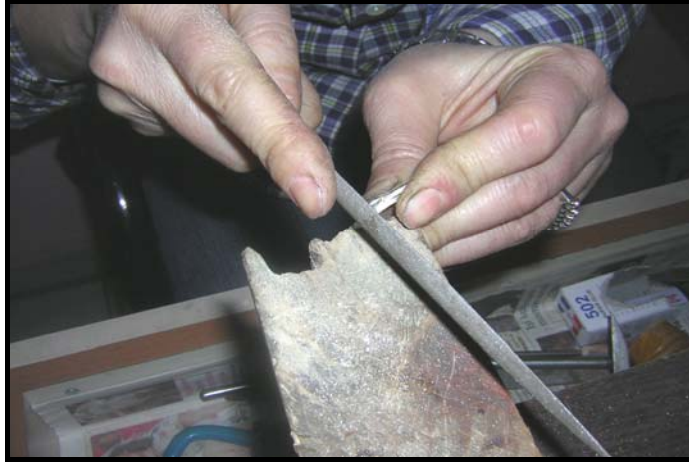
Fotoğraf No:205.Gümüş levhanın kenarlarındaki pürüzlerin eğe ile törpülenmesi işlemi.
