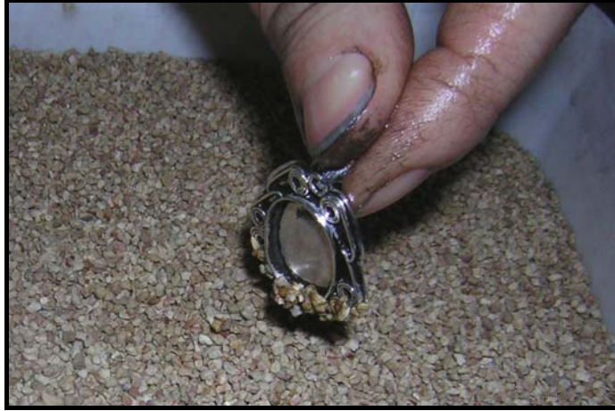
Fotoğraf No:216.Gümüş kolye ucunun ithal talaşta kurutulması işlemi.
