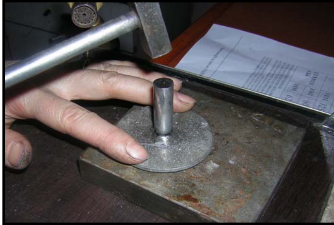
Fotoğraf No:201.Gümüş levhanın yüzeyinin düzleştirilmesi işlemi.
