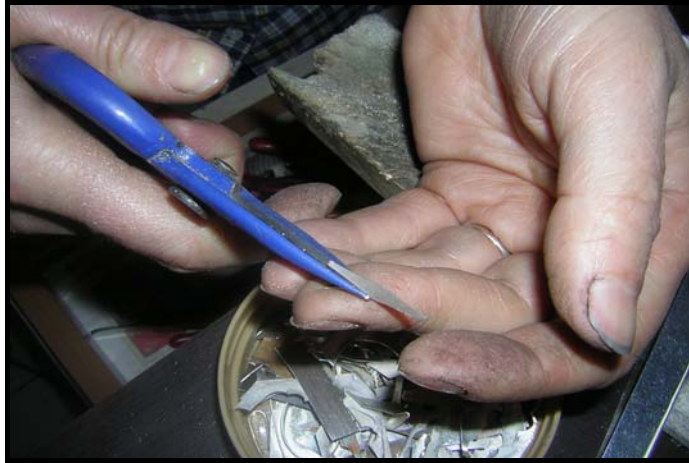
Fotoğraf No:207.Gümüş levhadan Antep makası ile kelebek kesme işlemi.
