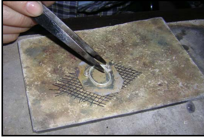
Fotoğraf No:199. Gümüş helezonların gümüş levha üzerine pens ile yerleştirilmesi işlemi.
