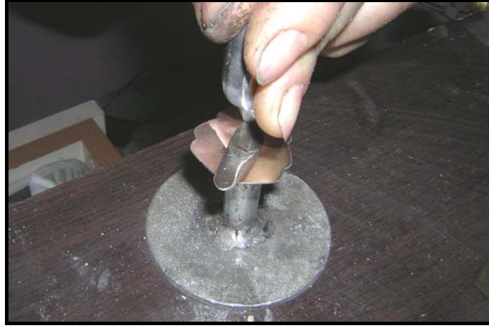
Fotoğraf No:217.Gümüş kolye ucunun arkasına 925 ayar damgası ve firma isminin damgalanması işlemi.
