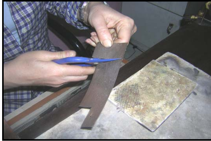
Fotoğraf No:190.Gümüş levhanın Antep makası ile kesilme işlemi.
