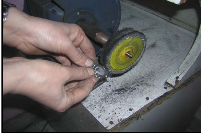
Fotoğraf No:213.Gümüş kolye ucunun cilalanma işlemi.
