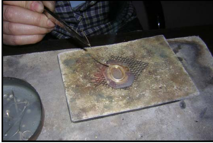
Fotoğraf No:198.Gümüş şeridin levhaya kaynak ile birleştirilmesi işlemi.
