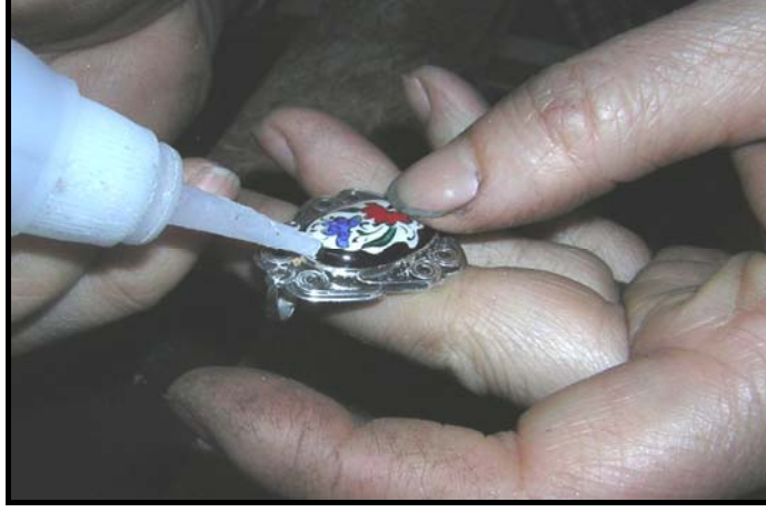
Fotoğraf No:219. Seramik takı altyapısının, gümüş levhaya kuvvetli yapıştırıcısı ile yapıştırılması işlemi.
