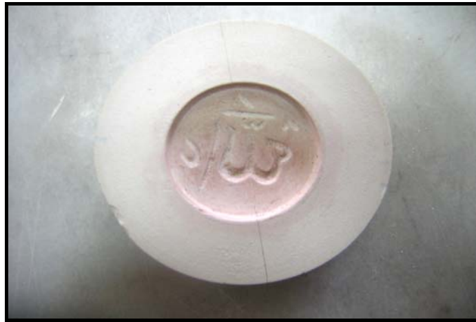
Fotoğraf No:171. Alçı kalıp ile şekillendirilen rölyefli seramik takı kalıbı.
