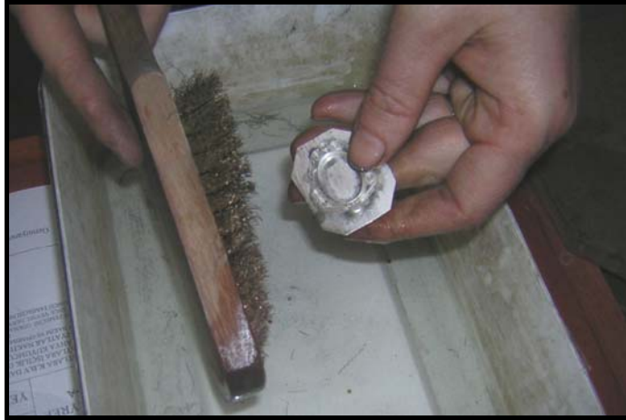
Fotoğraf No:203.Gümüş levhanın sabunlu suda tel fırça ile fırçalanması işlemi.
