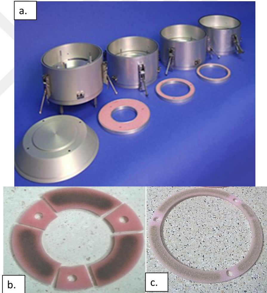
Şekil 3.16 a. Yüksek hacimli hava örnekleyicisinin kademeleri ve içlerine yerleştirilen poliüretan filtreler, b. PM10 filtresi, c. PM2.5 filtresi
