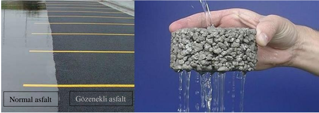
Şekil 5.5 Su geçirimli yüzey kaplamaları (Anonymus, 2019e)
