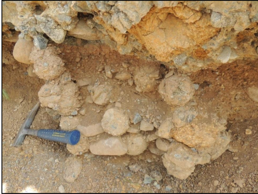
Şekil 3.45 İnceler mevkiinde gözlenen çakıllı çamurtopları (Tabaka düzlemi K30D, 6GD olarak ölçülmüştür)
