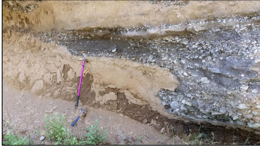
Şekil 3.40 Sarı renkli orta taneli kumtaşları ve aralarında merceksi şekilde görünen konglomeralar (Tabakaların konumu K45D, 10 GD olarak ölçülmüştür)
