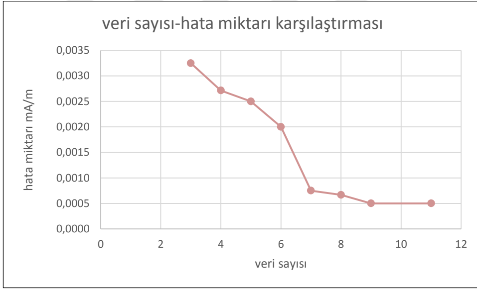
Şekil 7.53 50 W KFL için 301-600 MHz frekans aralığındaki manyetik alan veri sayısı hata miktarı karşılaştırması
