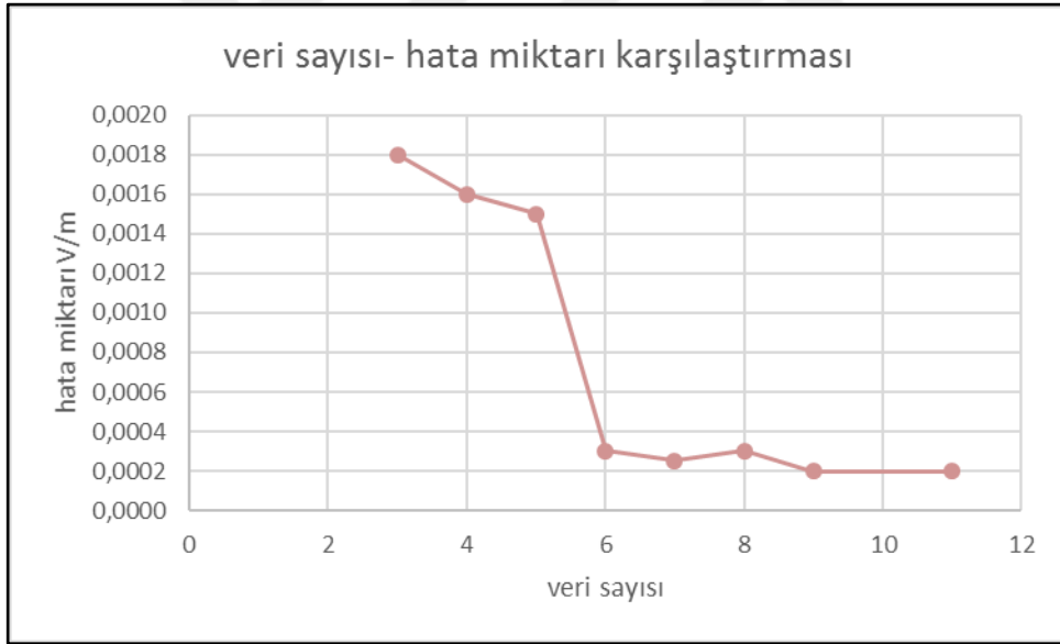
Şekil 7.45 30 W KFL için 601-900 MHz frekans aralığındaki elektirik alan veri sayısı hata miktarı karşılaştırması
