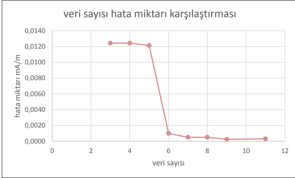
Şekil 7.48 30 W KFL için 601-900 MHz frekans aralığındaki manyetik alan veri sayısı hata miktarı karşılaştırması
