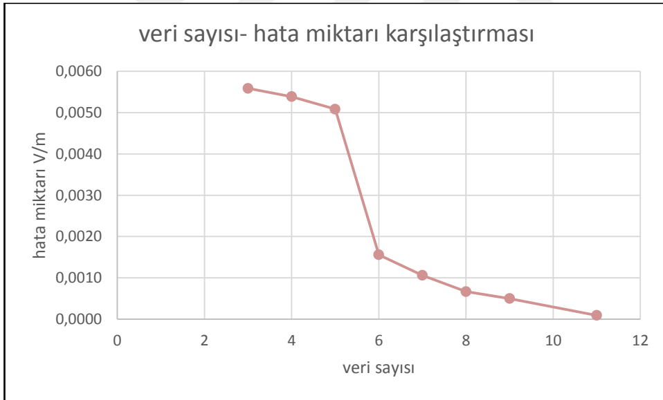
Şekil 7.33 8 W KFL için 301-600 MHz frekans aralığındaki elektrik alan veri sayısı hata miktarı karşılaştırması
