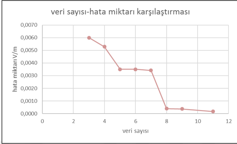
Şekil 7.60 73 W KFL için 601-900 frekans aralığındaki manyetik alan veri sayısı hata miktarı karşılaştırması
