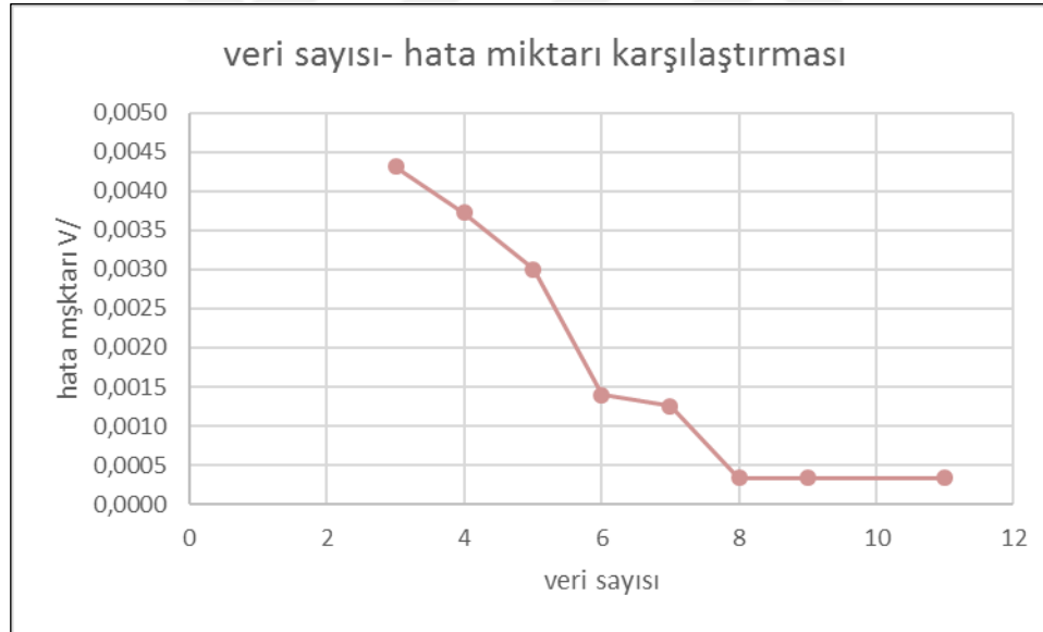
Şekil 7.55 73 W KFL için 50-300 MHz frekans aralığındaki elektrik alan veri sayısı hata miktarı karşılaştırması
