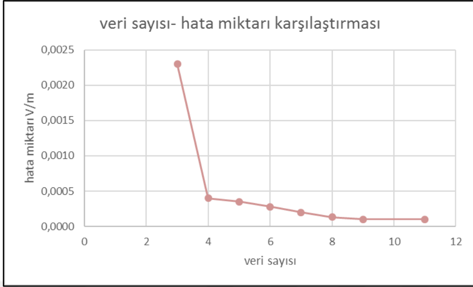
Şekil 7.40 15 W KFL için 601-900 MHz frekans aralığındaki elektrik alan veri sayısı hata miktarı karşılaştırması
