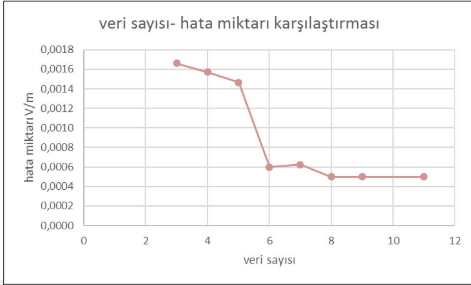
Şekil 7.56 73 W KFL için 301-600 MHz frekans aralığındaki elektrik alan veri sayısı hata miktarı karşılaştırması
