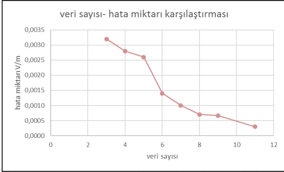
Şekil 7.38 15 W KFL için 50-300 MHz frekans aralığındaki elektrik alan veri sayısı hata miktarı karşılaştırması
