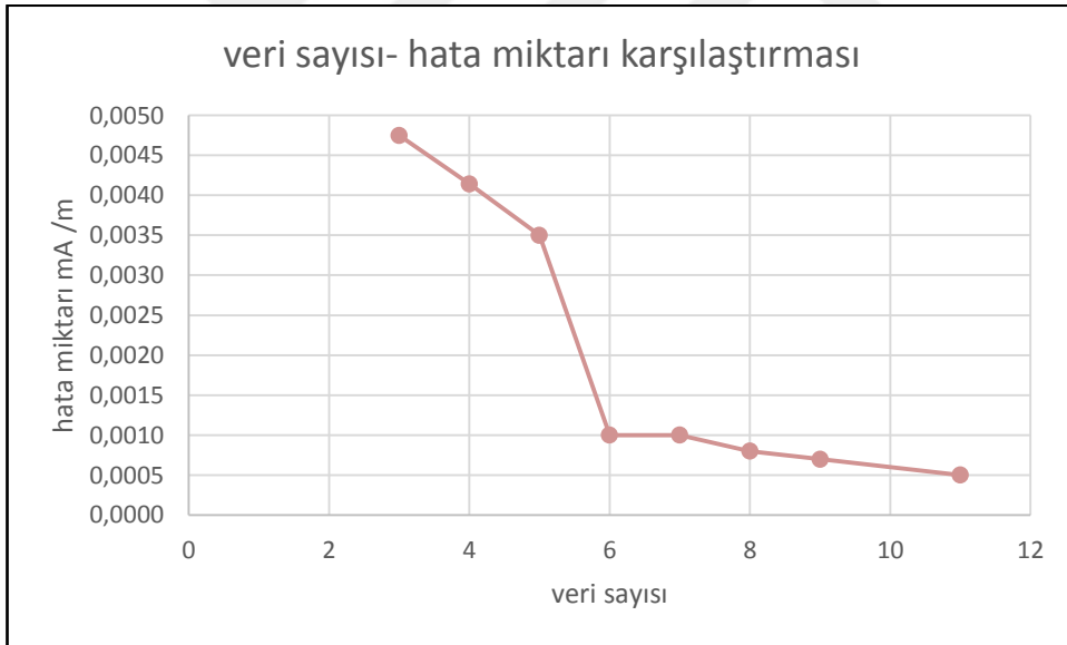
Şekil 7.37 8 W KFL için 601-900 MHz frekans aralığındaki manyetik alan veri sayısı hata miktarı karşılaştırması
