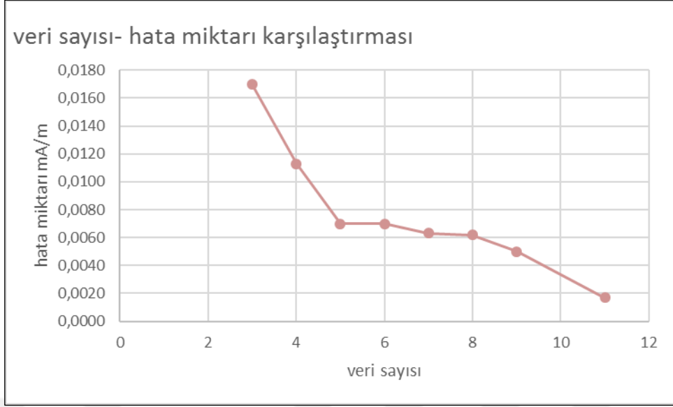
Şekil 7.58 W 73 W KFL için 50-300 MHz frekans aralığındaki manyetik alan veri sayısı hata miktarı karşılaştırması
