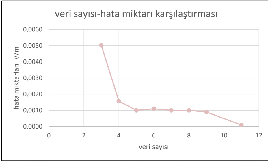
Şekil 7.34 8 W KFL için 601-900 MHz frekans aralığındaki elektrik alan veri sayısı hata miktarı karşılaştırması
