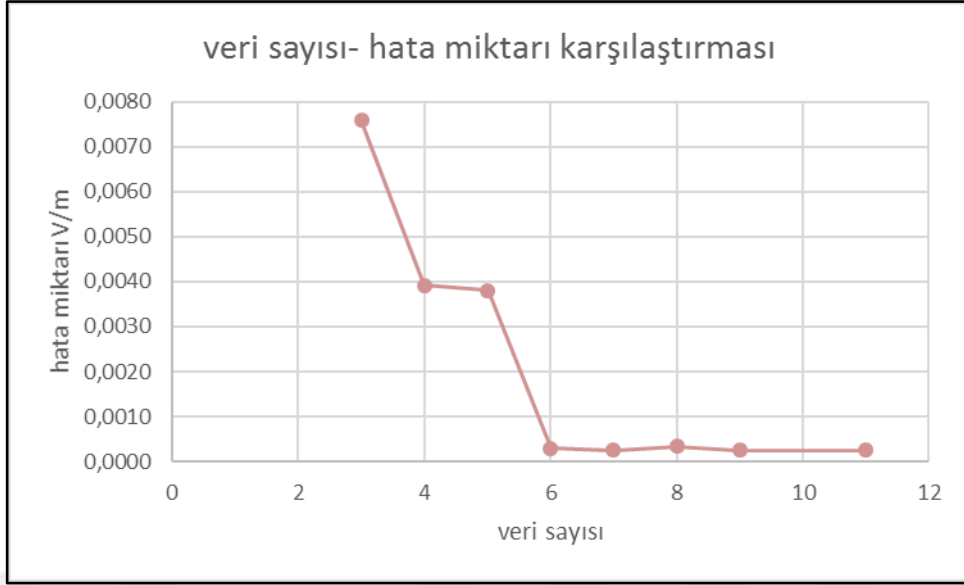
Şekil 7.44 30 W KFL 301-600 MHz frekans aralığındaki elektrik alan veri sayısı hata miktarı karşılaştırması
