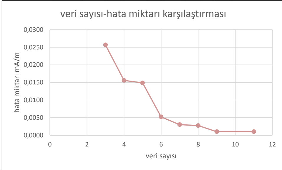
Şekil 5.59 73 W KFL için 301-600 MHz frekans aralığındaki manyetik alan veri sayısı hata miktarı karşılaştırması
