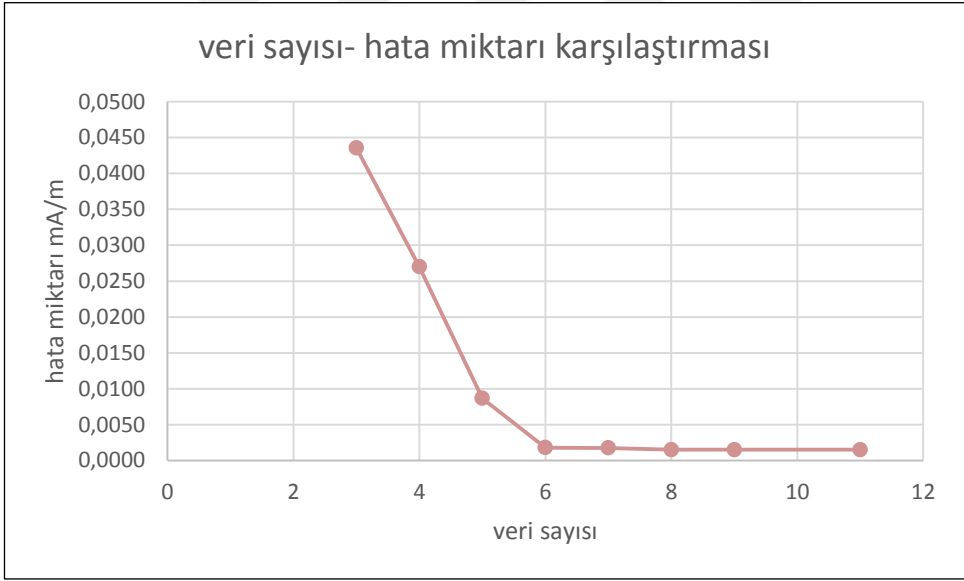
Şekil 7.41 15 W KFL için 50-300 MHz frekans aralığındaki manyetik alan veri sayısı hata miktarı karşılaştırması
