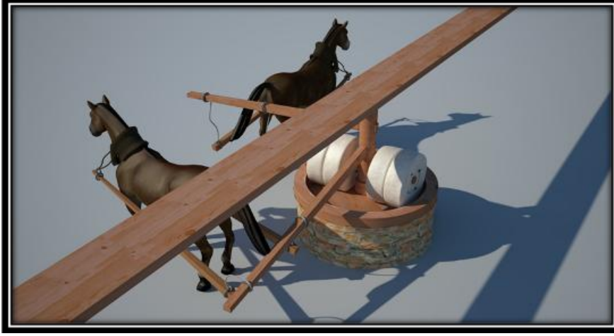
Resim 10: Barutçubaşı Simon Tarafından Çizilmiş Kükürt Değirmeni Resminin Üç Boyutlu Modellemesinin Üstünden Bir Kesit
