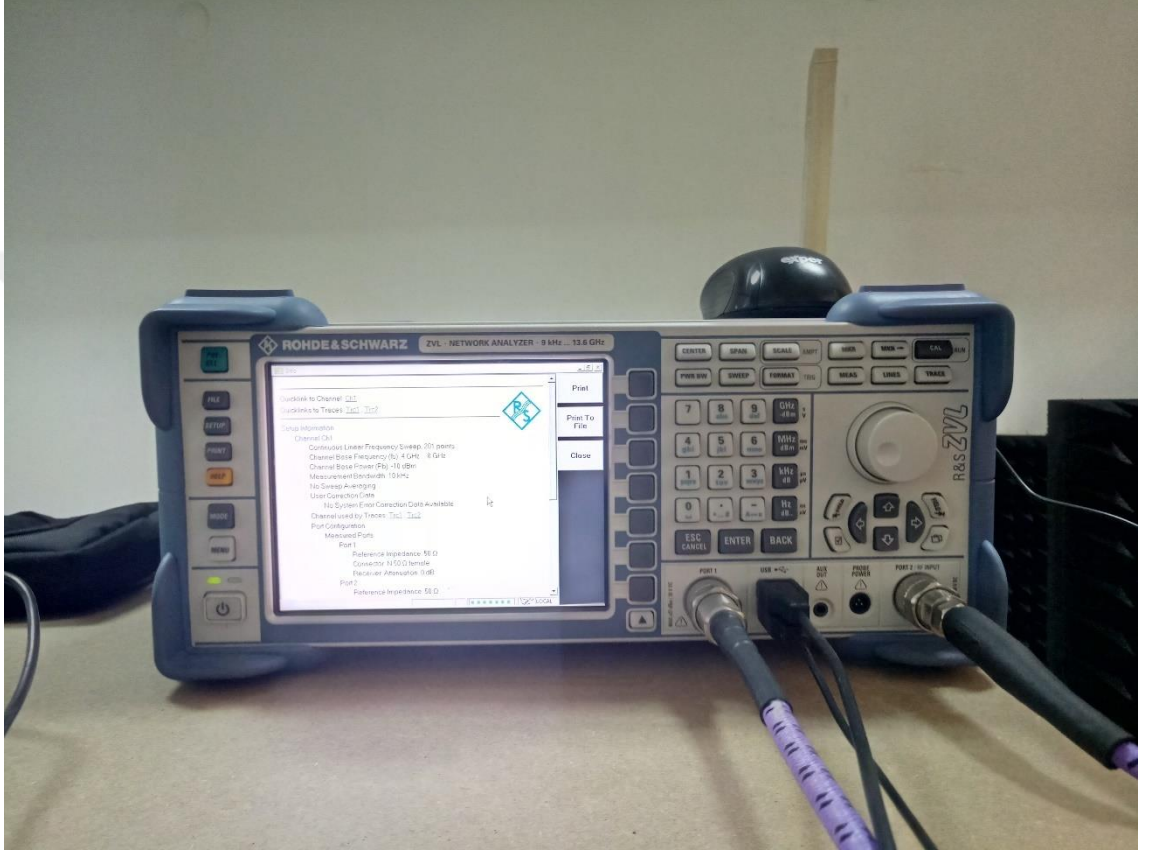
Şekil 5.3 Deneysel saçılma parametrelerinin elde edilmesinde kullanılan network analizörü
