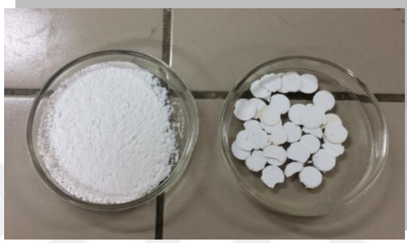
Şekil 3.5 Toz halde ve pellet yapılmış katalizörler
