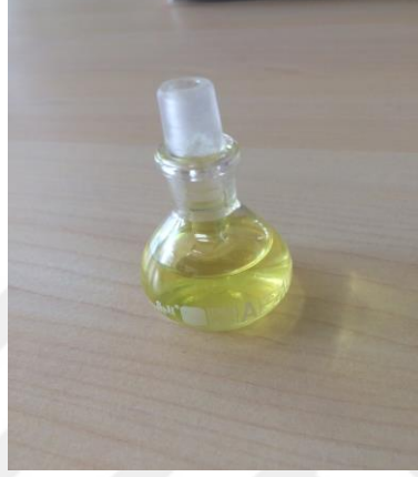
Şekil 3.7 Piknometre aleti fotoğrafı
