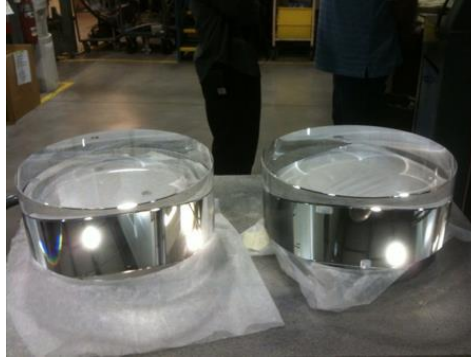
Şekil 4.3 LIGO' nun her biri 40 kg ağırlığındaki saf silika aynalarından ikisi
