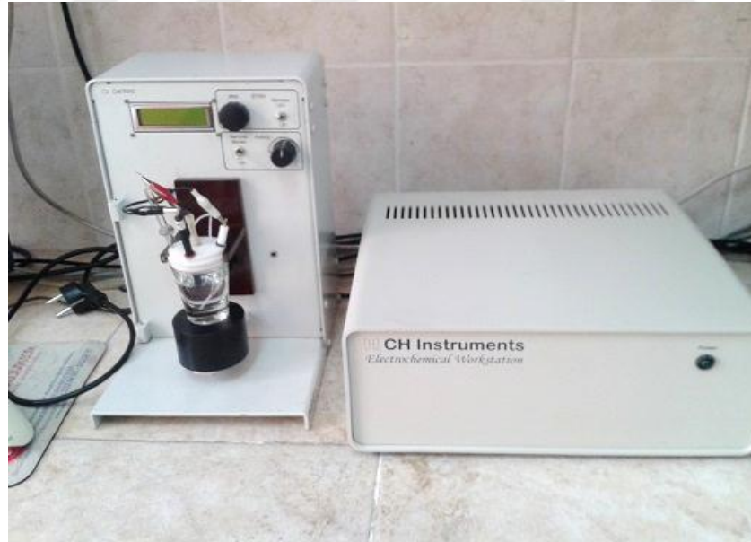
Şekil 3.1 Çalışma yapılan katı elektrot hücre standı ve elektrokimyasal sistem
