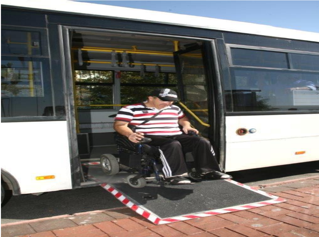
Resim 4: Toplu Ulaşım Aracı Engelli Rampası – Alanya
