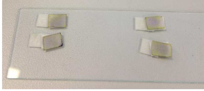
Şekil 4.31 Belirtilen konsantrasyonlardaki 3 boyutlu kağıt tabanlı platform denemesi
