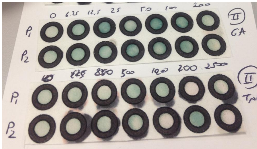
Şekil 4.8 Belirtilen miktarlardaki gallik asit ve troloks standartlarının uygulanması
