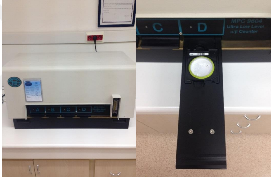
Şekil 3.1 Düşük zemin sayımlı gaz orantılı dedektör (Protean Instrument Corporation MPC-9604)
