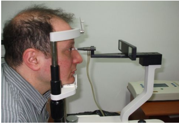
Resim 3. Bir olguda pulsatil oküler kan akımı analizatörü ile oküler kan akımının ölçümü
