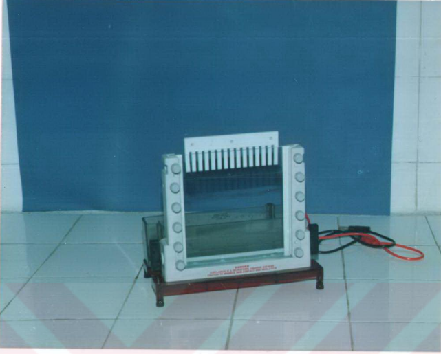
Şekil 3.9. Yığılma jeline tarağın batırılarak numune kuyuları elde etmek amacıyla polimerizasyonun beklenmesi aşaması.
