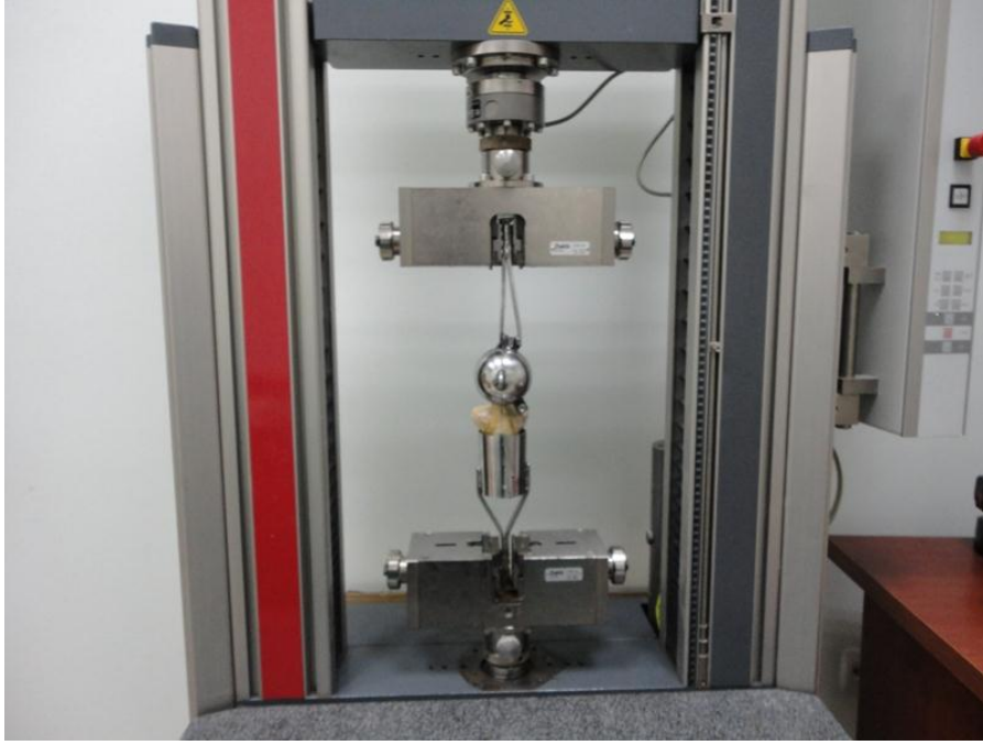
Şekil 11. Materyalin Test Makinesinde Çalışma Başlamadan Önceki Durumu ve Test Cihazı Görülmektedir
