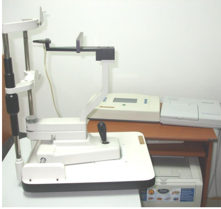
Resim 3. Çalışmada kullanılan Paradigm Dicon marka pulsatil oküler kan akımı analizatörü
