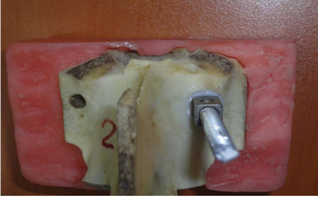
Şekil-7: İnek vertebraında kemik cement ile desteklenmiş transpediküler vida
