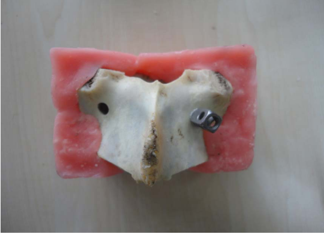
Şekil-6 : İnek vertebraasında dübel ile desteklenmiş transpediküler vida
