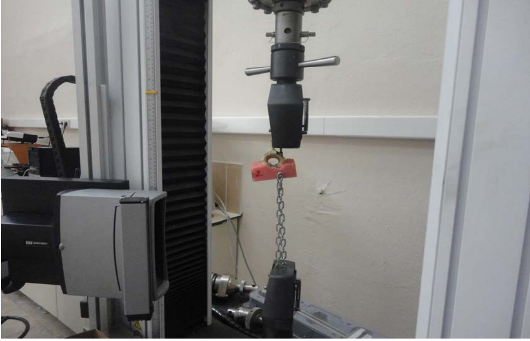
Şekil - 11 : Instron-382 çekme kuvvet uygulayacak alete bağlanmış model. Makinenin distal kolu sabit kalarak proksimal kuvvet kolundan çekme kuvveti uygulanmıştır.
