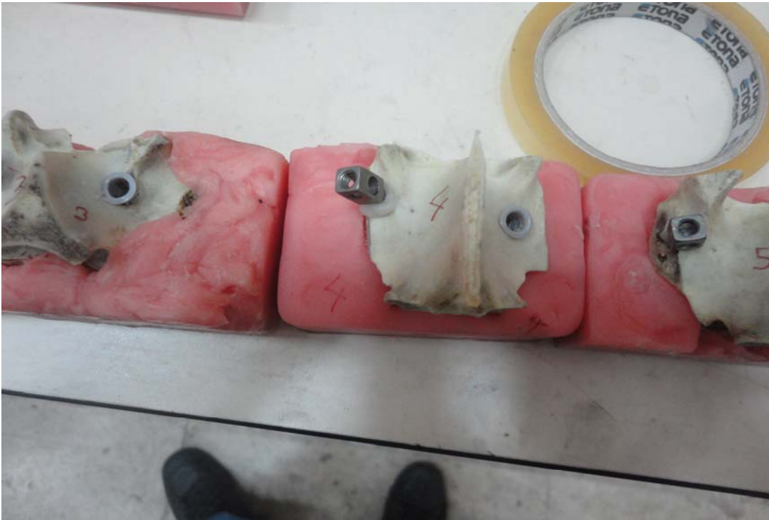
Şekil 8 : Taze donmuş inek vertebraı üzerinde bone cement ve dübel yerleřtirilmiř model
