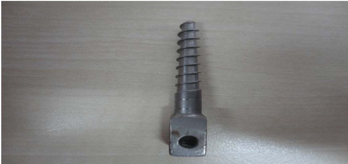
Şekil – 5 : Çalışmamızda kullanılan 4 x 40 mm boyutlarında üzerinde 8 ( sekiz ) yiv bulunan titanyum alaşımlı vida
