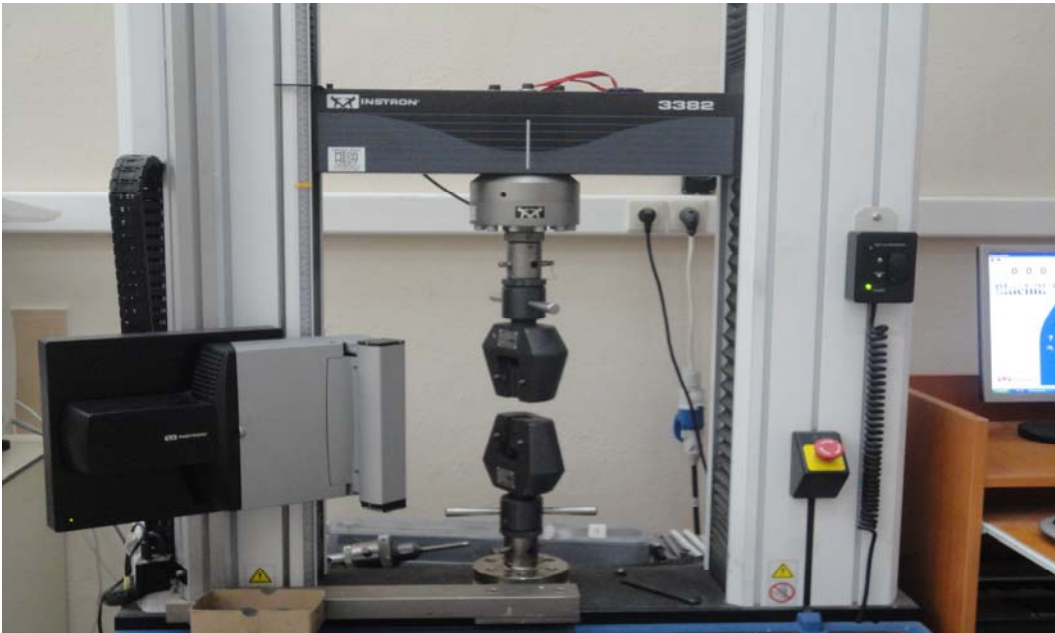
Şekil - 10 : İnek vertebrasında dübel veya kemek cement ile desteklenmiş transpediküler vidaya mekanik çekme kuvveti uygulanacak alet ( Instron 3382 )
