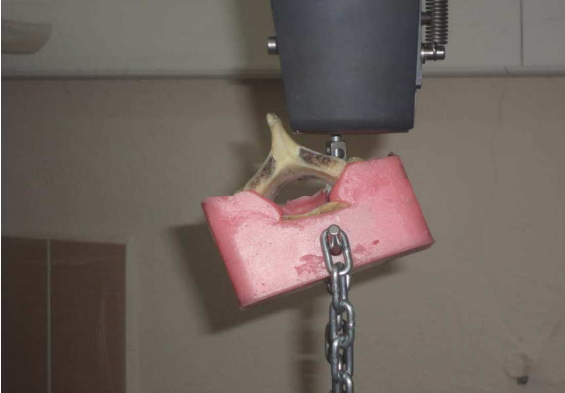
Şekil – 12: Makineye bağlantısı yapılmış olan modelin ağırlık merkezi hesaplaması yapılmış olup kuvvet kolları aynı doğru üzerine getirilmiştir.
