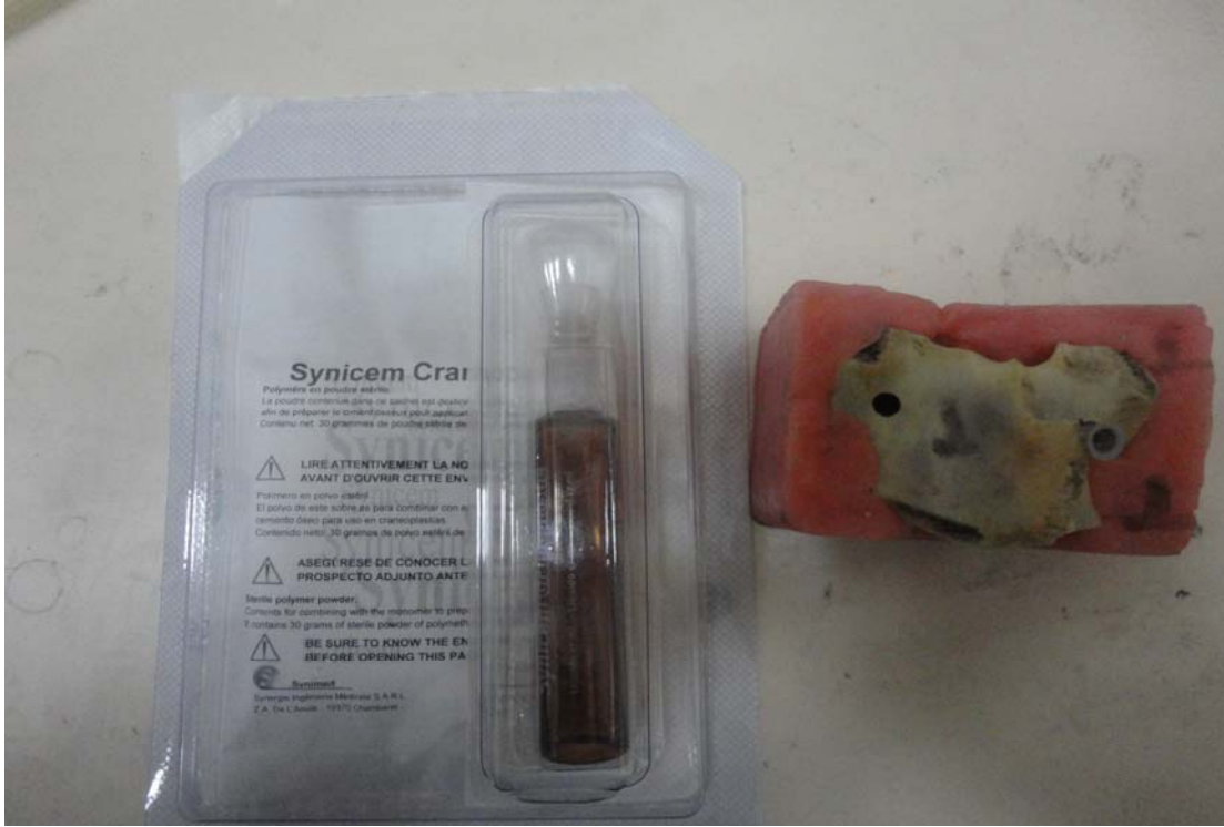
Şekil-4 : İnek vertebrasında transpediküler vidayı sabitlemek için kullanılan kemik cement ( İçerik : polimetilmetacrilate ve ticari ismi synchronic cranioplastie'dir. )
