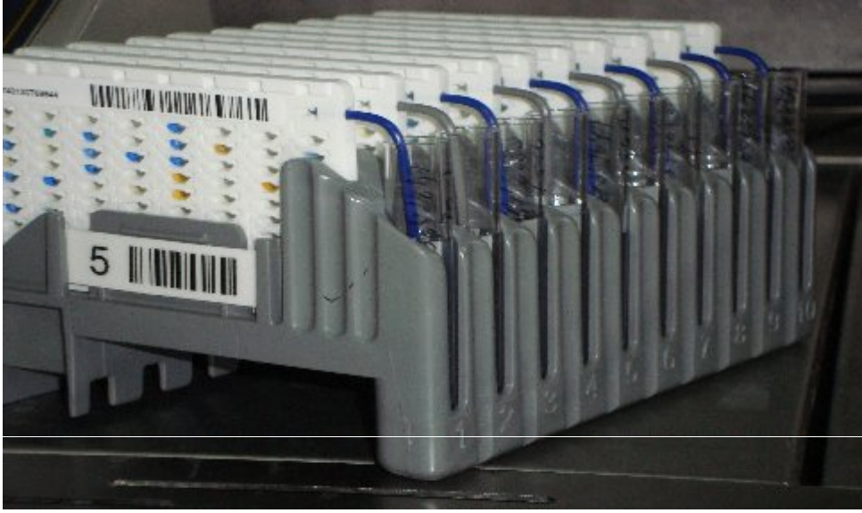
Resim 4: VITEK 2 cihazına koyulmak üzere hazırlanmış identifikasyon kartları
