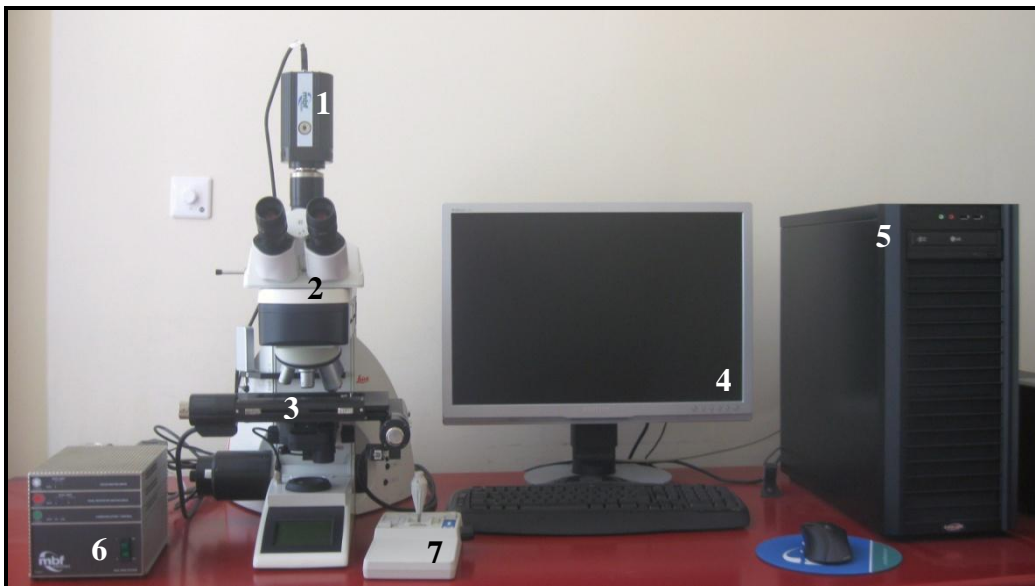
Şekil 7. Stereoloji Analiz Sistemi. (1) Kamera, (2) Mikroskop, (3) Otomatik Tabla, (4) Monitor, (5) Bilgisayar Kasası, (6) Kontrol Ünitesi, (7) El Kumandası.
