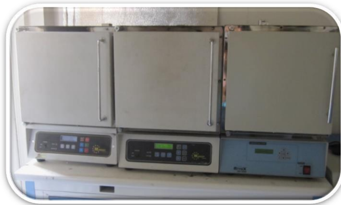
Resim 9. Revetman ön ısıtma fırınları
