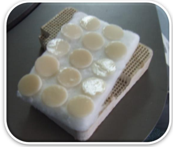
Resim 26, 27. Porselen örneklerin glaze fırınında ısıtılması
