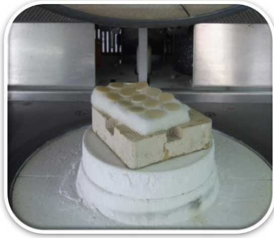
Resim 26, 27. Porselen örneklerin glaze fırınında ısıtılması
