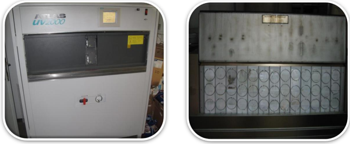
Resim 58, 59. Hızlandırılmış eskitme test cihazı (Atlas UV 2000)
