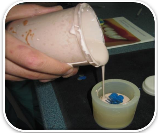
Resim 8. Revetmanın manşete dökülmesi
