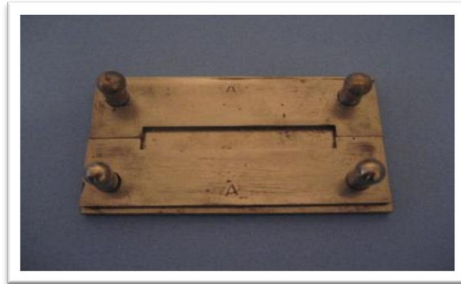
Resim 1. Test örneklerinin hazırlanmasında kullanılan paslanmaz çelik kalıp
