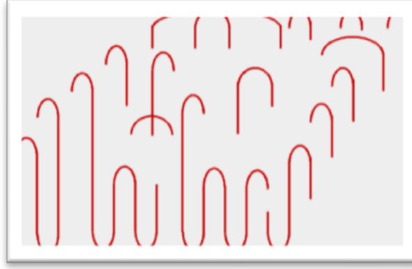
Şekil 5. Polimerlerin kristalin yapı düzeni
