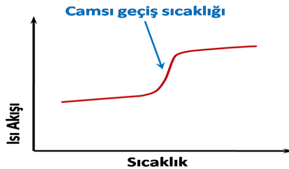
Şekil 24. Isıtılan polimerin camsı geçiş sıcaklık eğrisi
