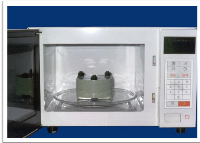
Resim 10. Mikrodalga enerjisi ile polimerizasyon yönteminde kullanılan mikrodalga fırın görüntüsü
