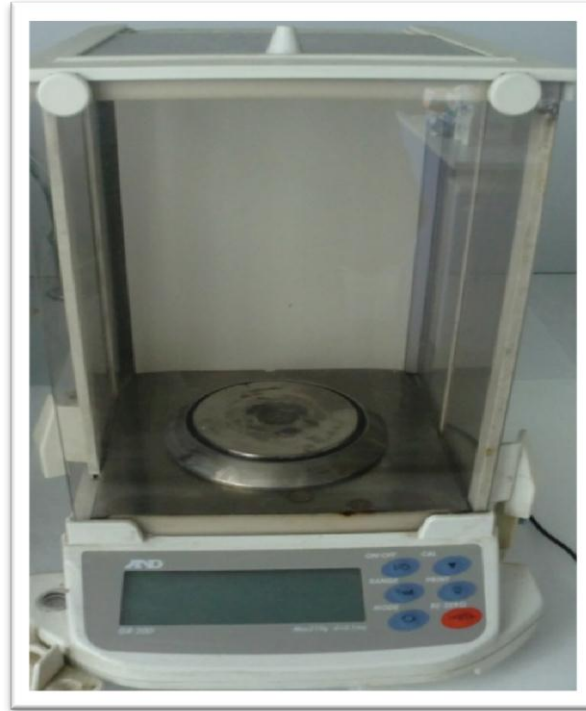
Resim 2. Monomer ağırlıklarının ölçüldüğü hassas terazi
