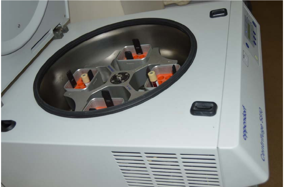
Resim-7: PRP tüplerinin santrifüj cihazına yerleştirilmesi
