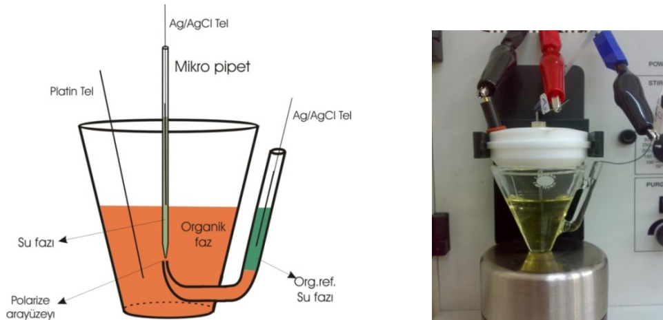
Şekil 3.5 Kullanılan \mu\text{ITIES} hücresi ve C3 hücre standına yerleşimi
