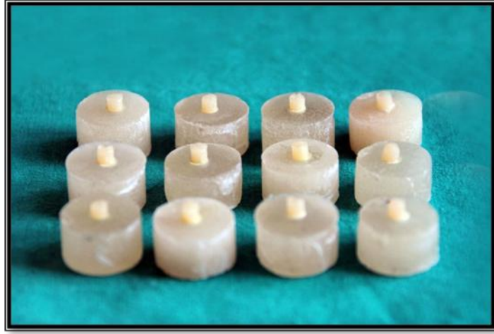
Resim 7 MTA/Adeziv Makaslama Baęlanma Dayanımı için hazırlanan örnekler
