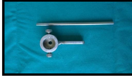
Resim 9 Akrilik blokları test cihazına sabitlemede kullanılan aparat
