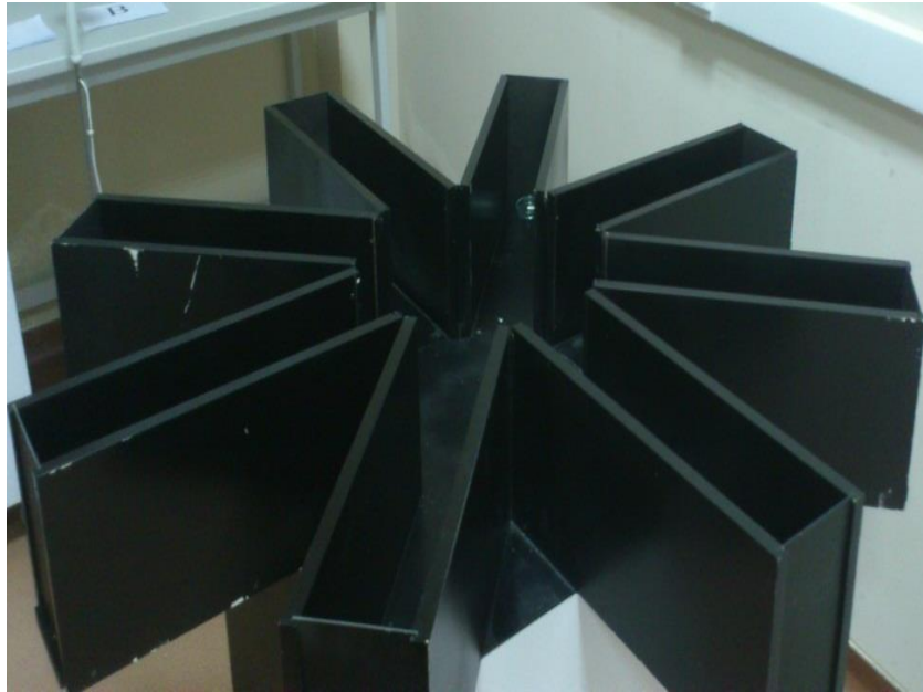
Resim 7. Sekiz kollu ışınsal labirent düzeneği
