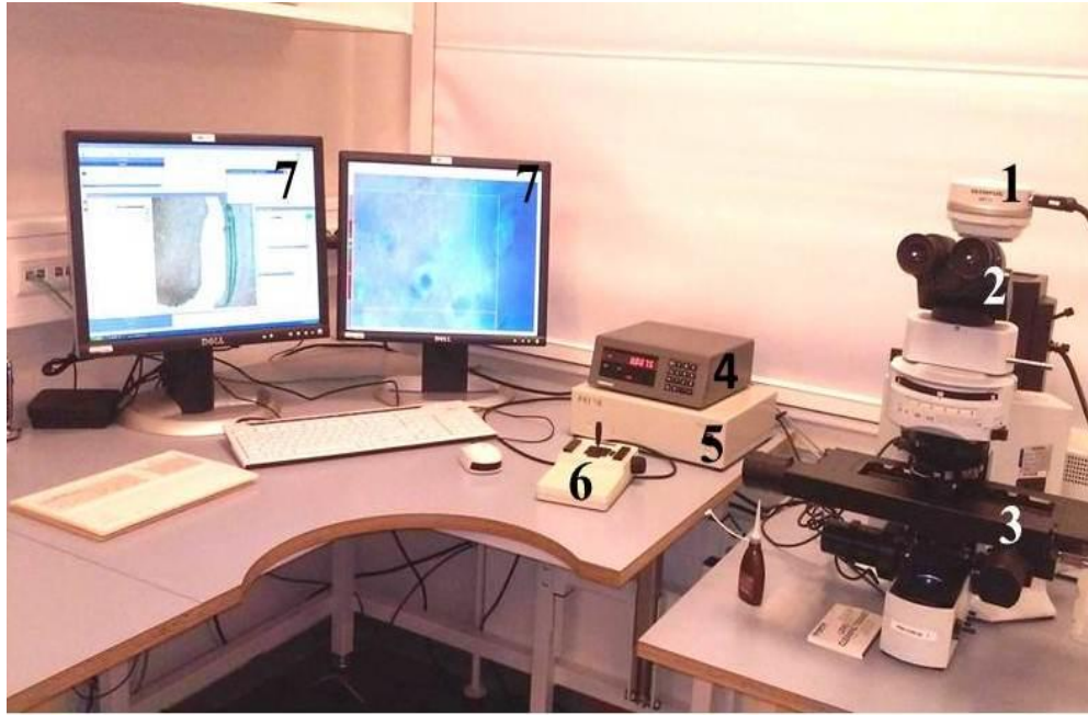
Resim 13. Danimarka Aarhus Üniversitesi, Stereoloji ve Elektron Mikroskopu Laboratuvarında bulunan Stereoloji Analiz Sistemi. (1) Kamera, (2) Oküler, (3) Otomatik Tabla, (4) Mikrokator (5) Kontrol Ünitesi, (6) Kontrol Paneli, (7) Monitorler
