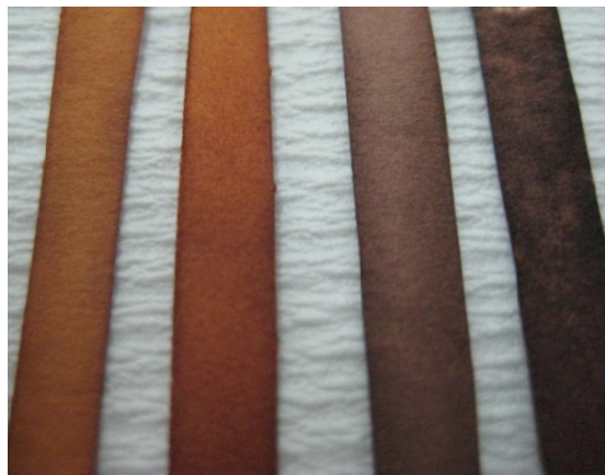
Şekil-5. 14: Artan Hg^{2+} iyon konsantrasyonuna karşı test kâğıtlarındaki renk değişimi
