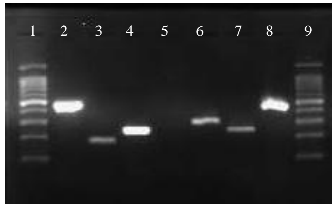
Resim 2. papA , papA allele F7-2, papA allele F8, papA allele F10, papA allele F16, cdtB Genlerine Ait Jel Elektroferez Görüntüsü 1: 100 bp DNA marker, 2: papA pozitif örnek, 3: papA allele F7-2 pozitif örnek, 4: papA allele F8 pozitif örnek, 5: Negatif kontrol, 6: papA allele F10 pozitif örnek, 7: papA allele F16 pozitif örnek, 8: cdtB pozitif örnek, 9: 100 bp DNA marker.
