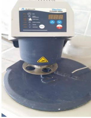
Resim 21-22. Zımpara Makinesi ve örneklerin makineye yerleştirilmesi için kullanılan kalıp
