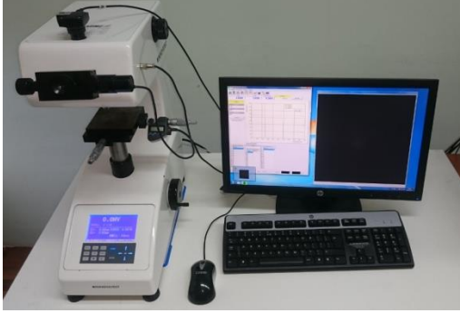
Resim 26-27. Vicker's Mikrosertlik Ölçüm Cihazı ve 40x büyütmedeki görüntüsü
