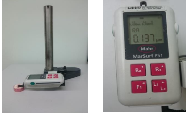
Resim 28-29. Örneklerin yüzey pürüzlülüğü ölçümü ve MahrSurf PS1 Germany Profilometre cihazı
