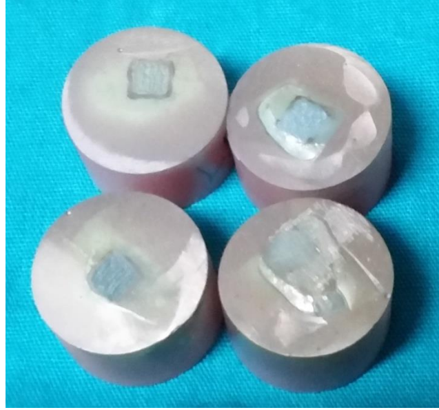
Resim 12. SEM görüntüsü için altın kaplanmış örnekler
