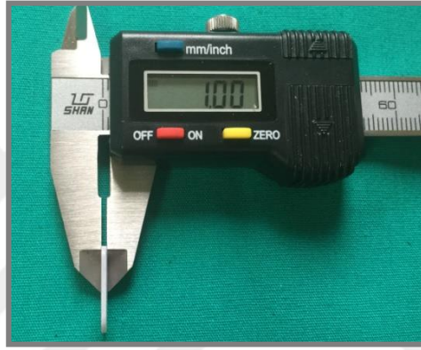
Resim 48. Yüzey işlemleri sonrası örnek kalınlığı kontrolü
