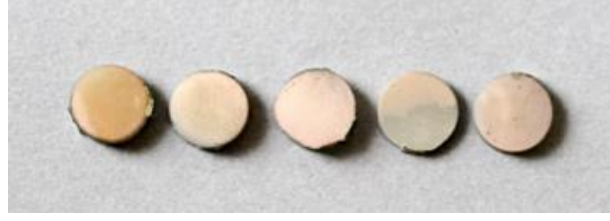
Resim 24: Örnek Yüzeylerinin Altın ile Kaplanmış Hali
