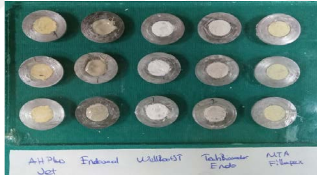
Resim 15. Sertleşme süresi testi için hazırlanan örnekler
