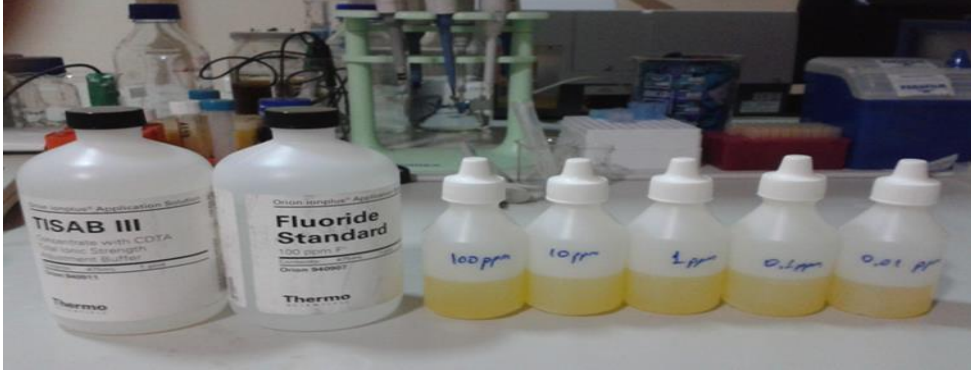
Resim 12. Florür iyonu ölçümünde kullanılan TISAB III ve standart florür solüsyonları
