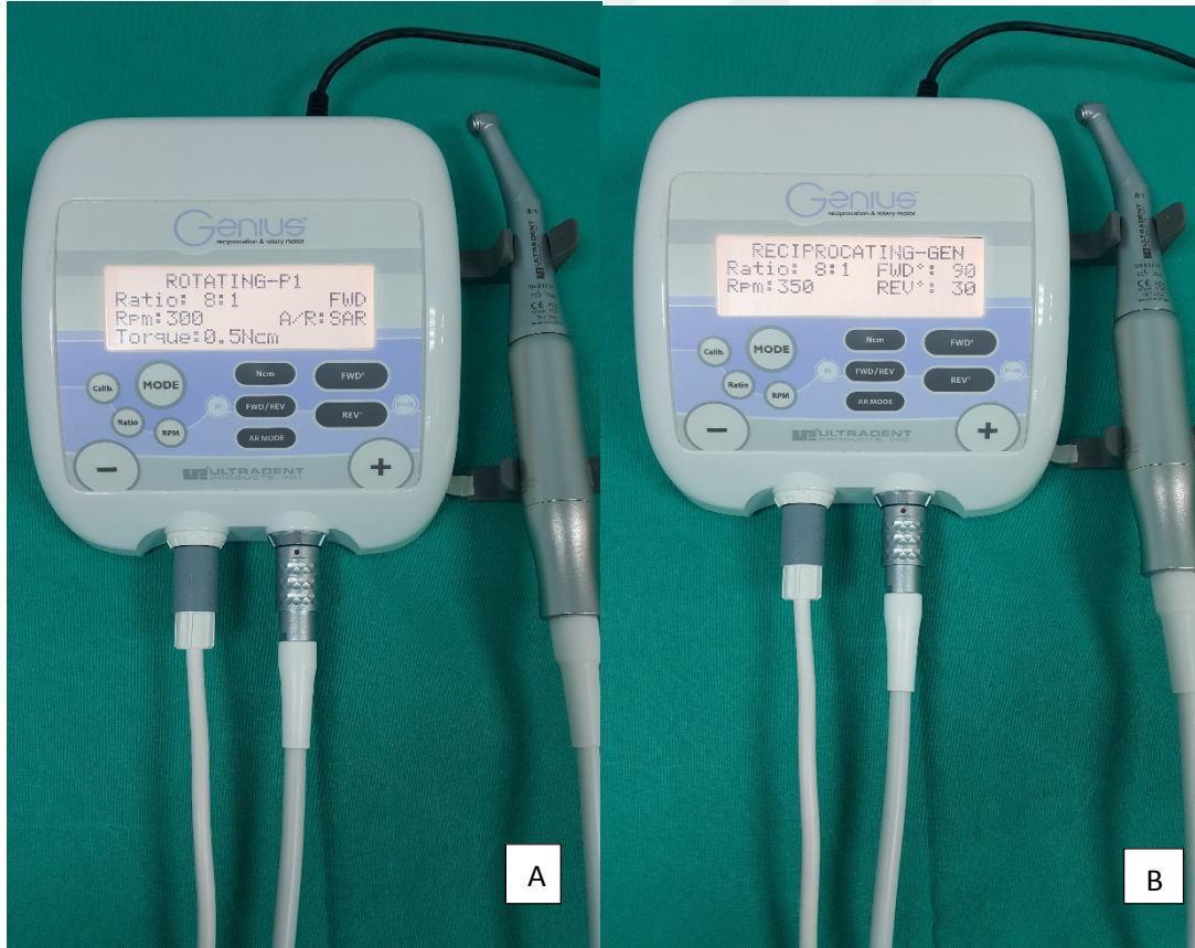
Resim 24. (A) Rotasyon ve (B) resiprokasyon hareketine ayarlanmış Endo-Eze Genius endodontik motor
