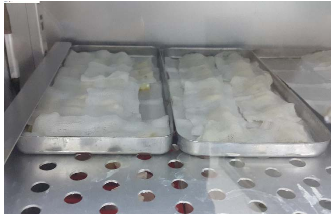
Resim 20. 37°C ve >%95 nemli ortam olan inkübatör içinde kanal dolumu yapılan örneklerin bir hafta bekletilmesi
