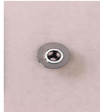
Resim 8: Ara parçanın üstten görünümü ve uçları sıkıca kavramaya yarayan mekanizma
