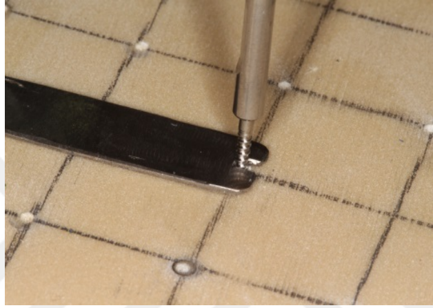
Resim 20: Mikro implantın boyun kısmına yerleştirilen 1.2 mm kalınlığında metal stoper
