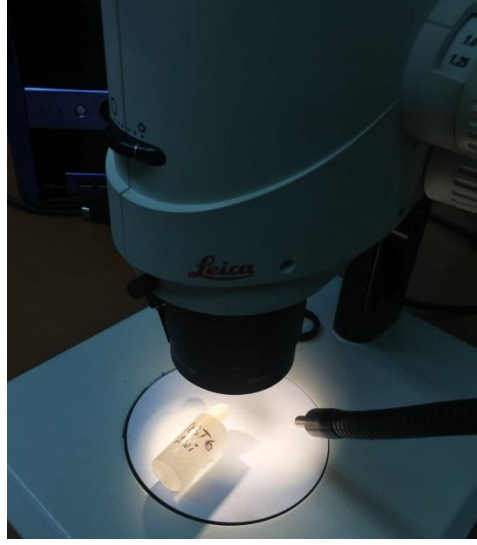
Resim 23: Stereo mikroskop ile örneklerin incelenmesi
