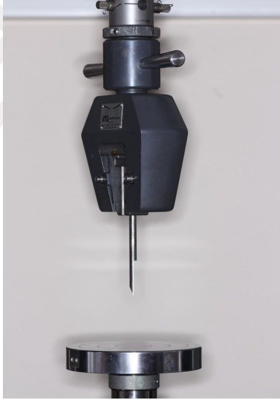
Resim 21: Üniversal test cihazının hareketli üst parçaya bağlanan ince uçlu, paslanmaz çelik bıçağı ve alt hareketsiz düz tablası
