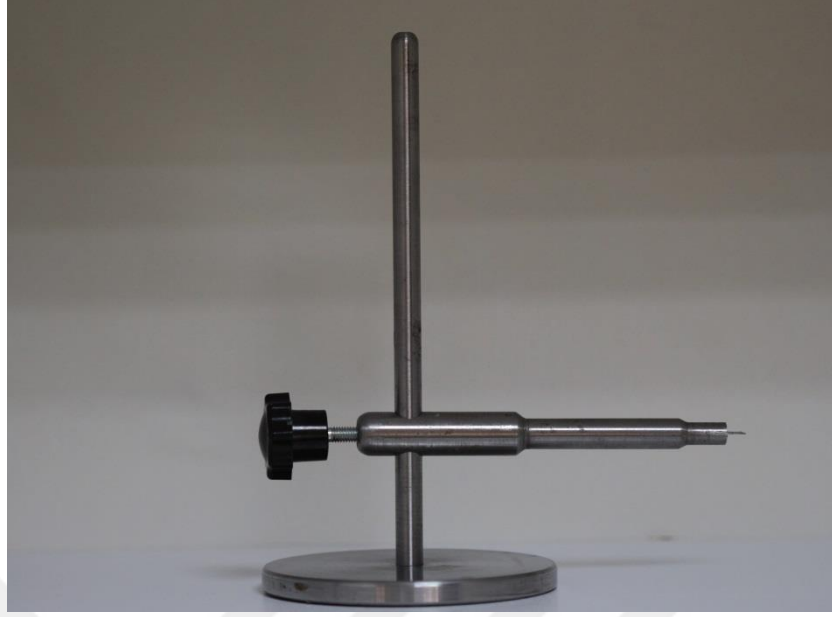
Resim 17: Braket kaidesinin makaslama kuvvetinin uygulanacağı dikey düzleme paralel olabilmesi için hazırlanan düzenek
