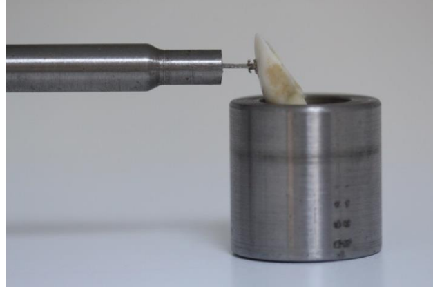
Resim 18: Düzeneğin hareketli kolunun uç kısmı braket slotuna girecek şekilde dişlerin pozisyonlandırılması
