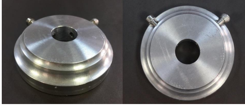
Resim 20: Örnekleri gelen makaslama kuvveti karşısında sabit tutmak için yapılan düzeneğin yandan ve üstten görünümü
