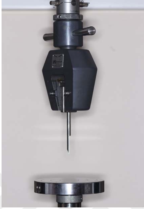
Şekil 22: Test cihazının üst parçasına sabitlenen ince uçlu paslanmaz çelik bıçak
