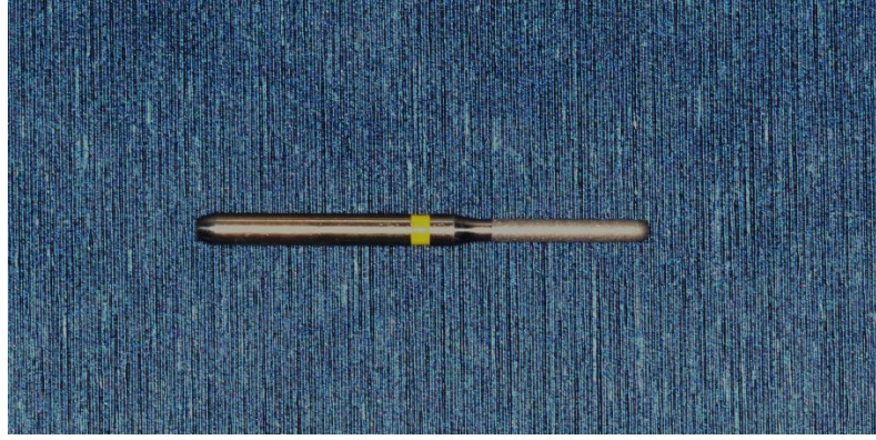
Şekil 10: Çalışmada kullanılan elmas frez
