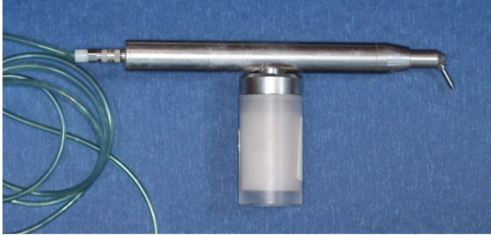
Şekil 8: Çalışmada kullanılan ağız içi kumlama cihazı
