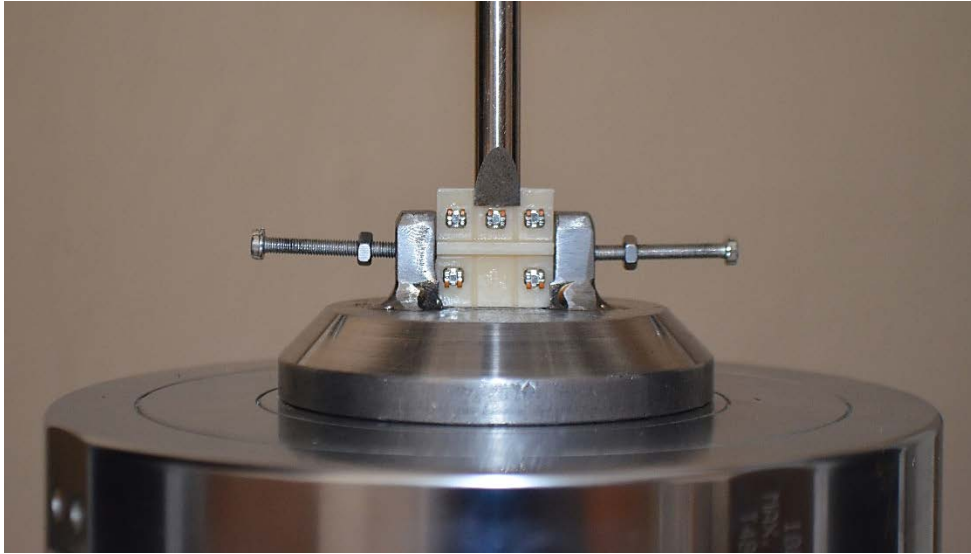
Şekil 23: Örneğin test cihazına yerleştirilmesi
