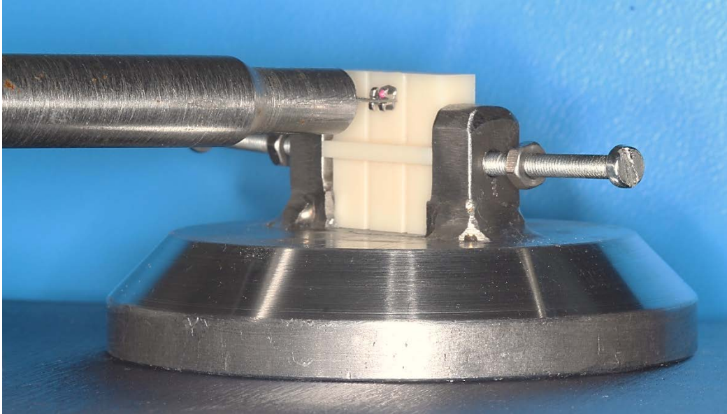
Şekil 16: Braket kaidesinin düzeneğin uç kısmı yardımıyla pozisyonlandırılması
