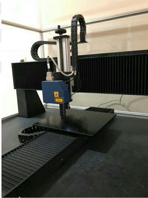
Şekil 25: İncelemede kullanılan profilometre cihazı
