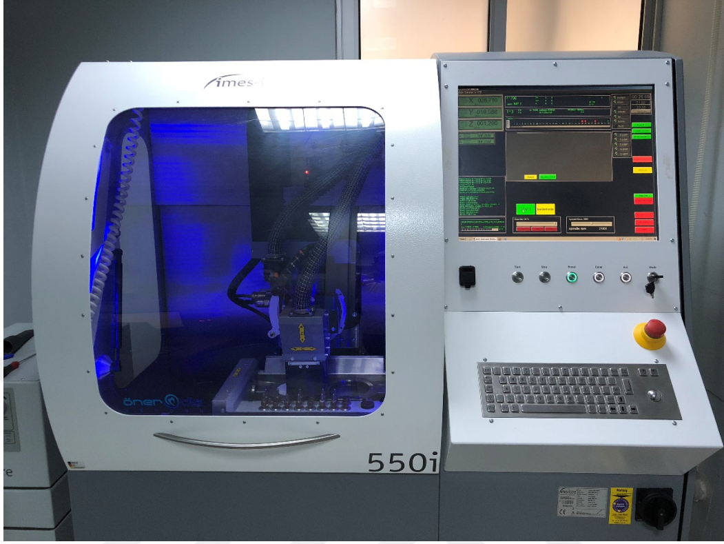
Şekil 2: Örneklerin üretilmesinde kullanılan CAD/CAM sistemi
