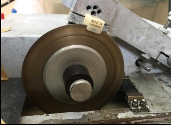
Resim 28: Isomet kesim cihazı ile blokların kesilmesi
