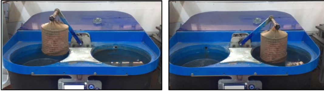
Resim 43 ve 44: Örneklerin termal yaşlandırma uygulanması
